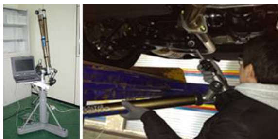
〈그림 3.2.9〉 대상 차량의 주요 Hard-Point 측정
