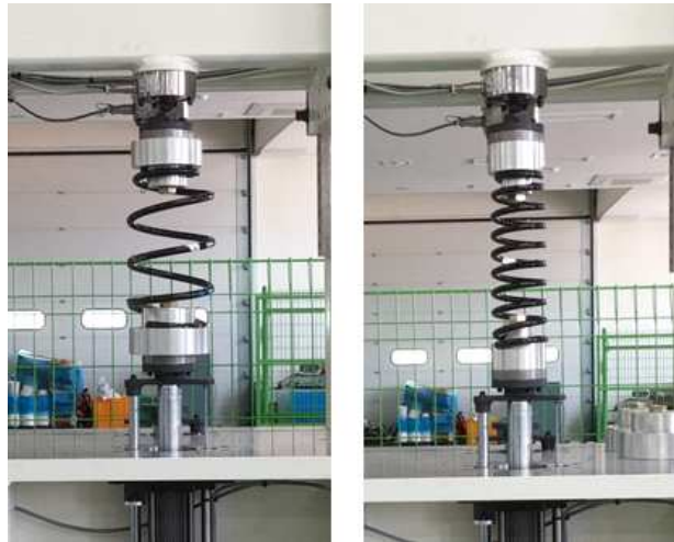
<그림 3.2.11> 전륜 및 후륜 Spring 특성 측정 실험
