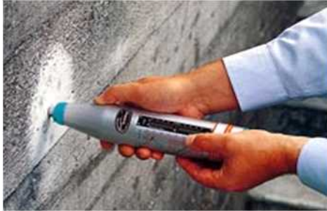
(a) 슈미트 햄머를 이용한 강도측정
