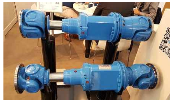
그림 12 InnoTrans 2016 출품한 GWB사의 안전장치 내장형 동력전달축 모습
