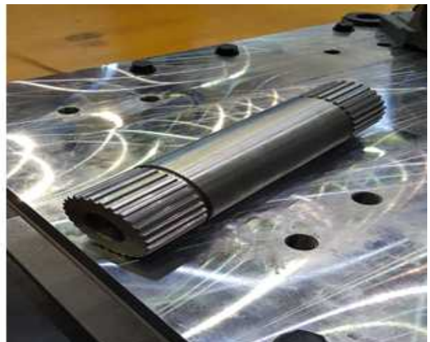
그림 71 축(FEMALE) 도면 및 형상
