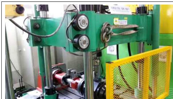
(그림 75 비틀림 파단시험 실시 장면)
