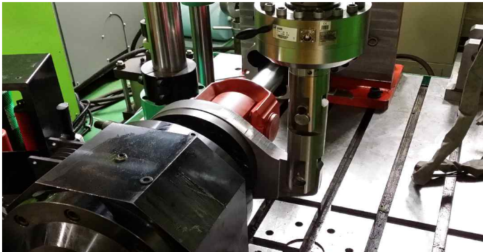
그림 58 비틀림 성능시험 장면 및 Fuse부 박리현상
