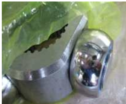
그림 51 Tripod unit & Ball bearing 조립
