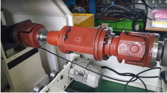
(그림 120 동력전달축의 언밸런스시험 장면)
