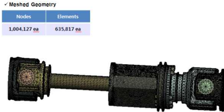
그림 29 트리포드 구동축 3D 유한요소 모델
