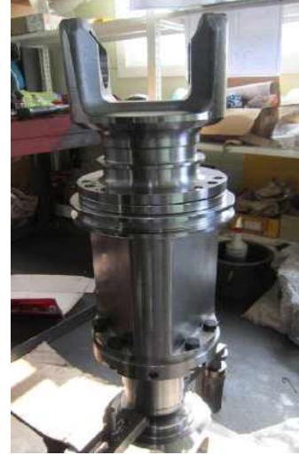
(그림 102 SHAFT, TRIPOD HOUSING, TRIPOD TUBE 및 LAW CLAMP 조립)
