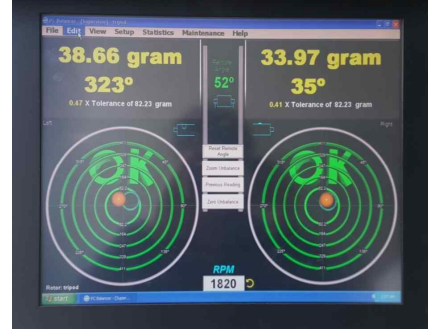
(그림 120 동력전달축의 언밸런스시험 장면)
