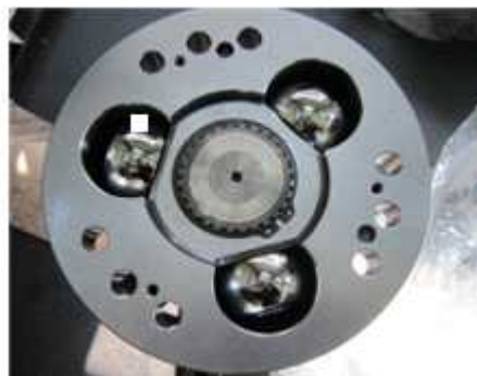
그림 51 Tripod unit & Ball bearing 조립
