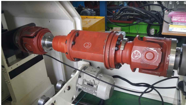
그림 57 동력전달축의 언밸런스시험 장면
