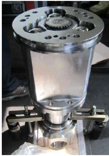
(그림 102 SHAFT, TRIPOD HOUSING, TRIPOD TUBE 및 LAW CLAMP 조립)
