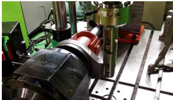
(그림 79 비틀림 피로시험시험 실시 장면)
