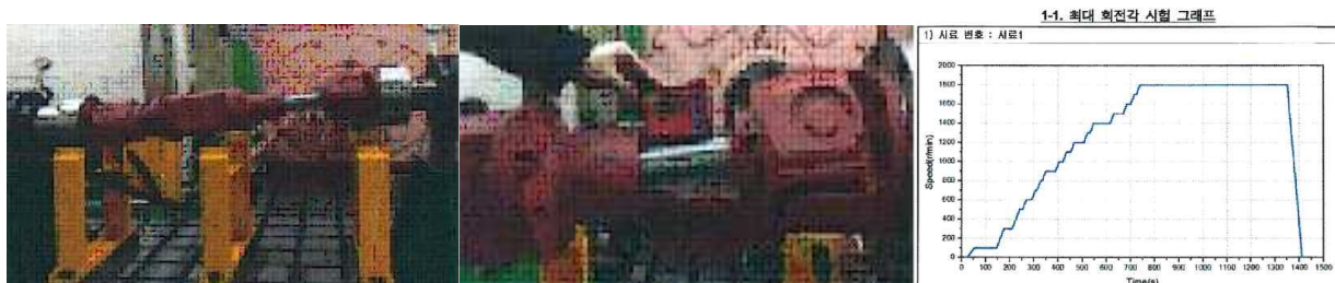
그림 136 최대 곱힘 각 및 최대 회전속도 시험
