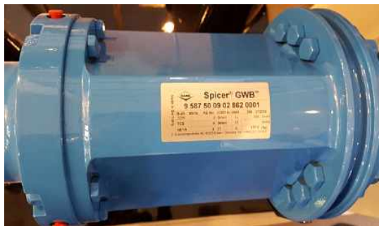
그림 12 InnoTrans 2016 출품한 GWB사의 안전장치 내장형 동력전달축 모습
