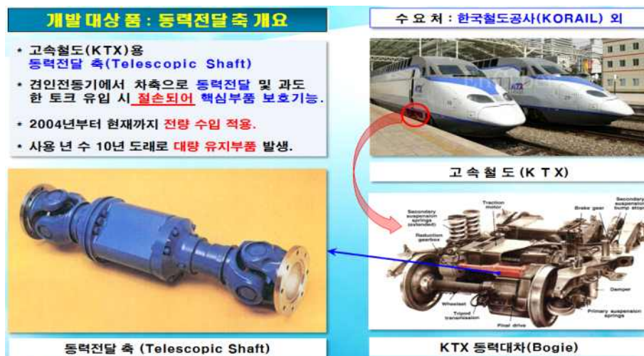
그림 1 KTX용 동력전달 축(Telescopic 구동축)의 형상 및 장착위치
