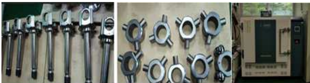
그림 180 트리포드 유닛 및 샤프트 조립간 열간압입 공정
