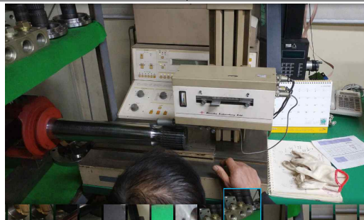
(그림 94 퓨즈 부 표면조도 측정(연마 후))
