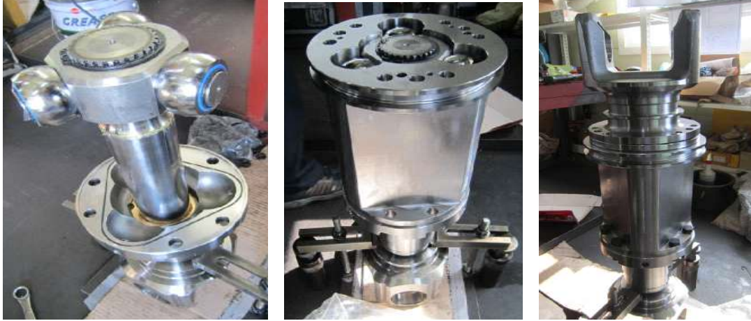
그림 52 SHAFT, TRIPOD HOUSING, TRIPOD TUBE 및 LAW CLAMP 조립
