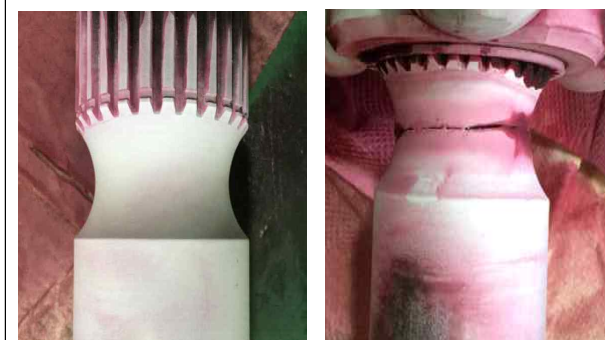
(그림 77 시험 전(좌) 및 시험 후(우) 파단 양상)
