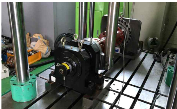
그림 140 비틀림 내구수명 시험
