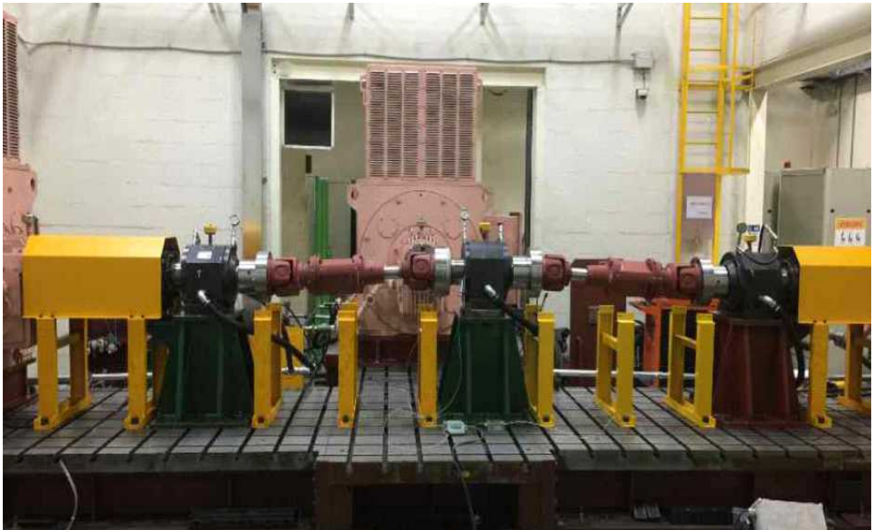
그림 158 가속수명시험용 최종시제 시편장착
