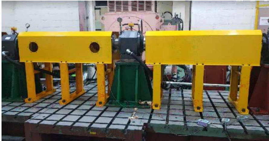
그림 148 동력전달 축 2단계 가속수명시험(1)
