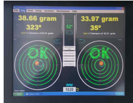
그림 57 동력전달축의 언밸런스시험 장면
