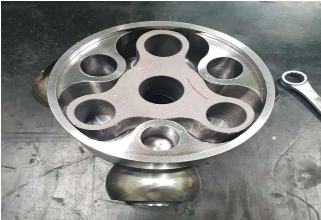
그림 155 최종시제 트리포드유닛 결합용 1차 퓨즈플레이트와 2차 퓨즈플레이트
