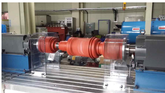
(그림 119 동력전달축의 굽힘 각도 측정 장면)
