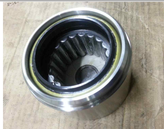
(그림 104 캡, 니들베어링 및 리테이너 조립형상)
