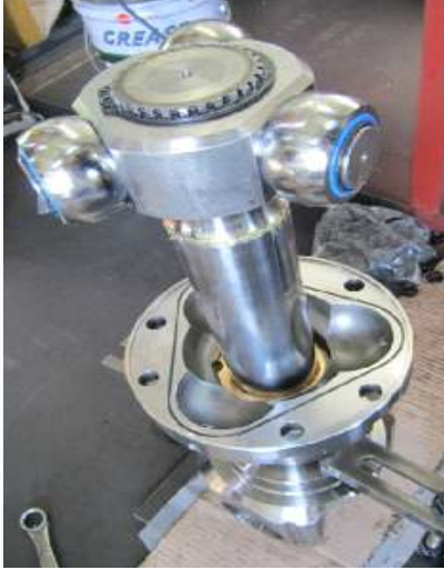
(그림 102 SHAFT, TRIPOD HOUSING, TRIPOD TUBE 및 LAW CLAMP 조립)
