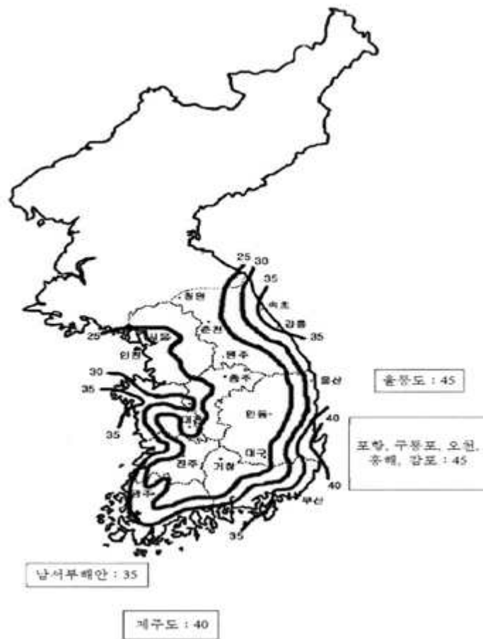
그림 12. 탱크 풍하중 설계기준 기본 풍속 분포도
