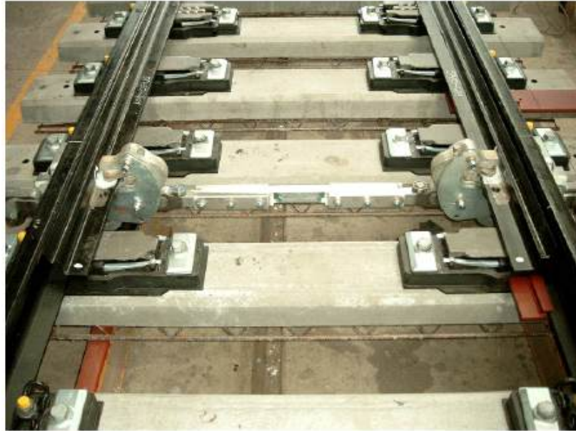
그림 2-19. 분기기 쇄정 장치
