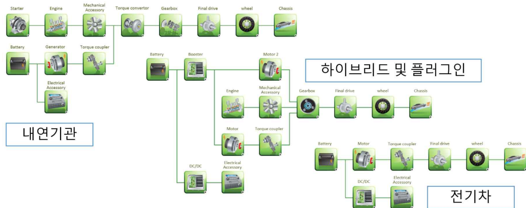
그림 1-9 Autonomie(Matlab Simulink) 기반으로 구성된 내연기관 차량, 하이브리드 전기차, 전기차 모델
