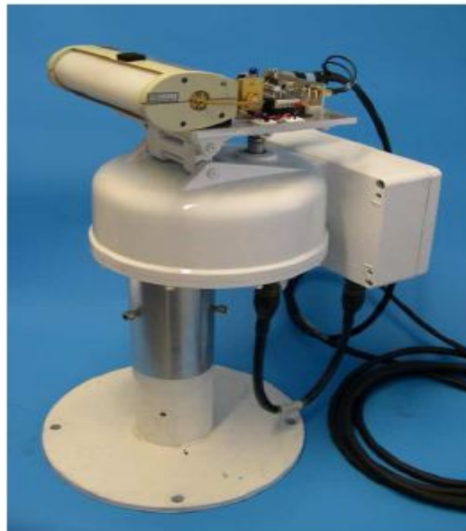
<그림 38 > FMCW Scanner
