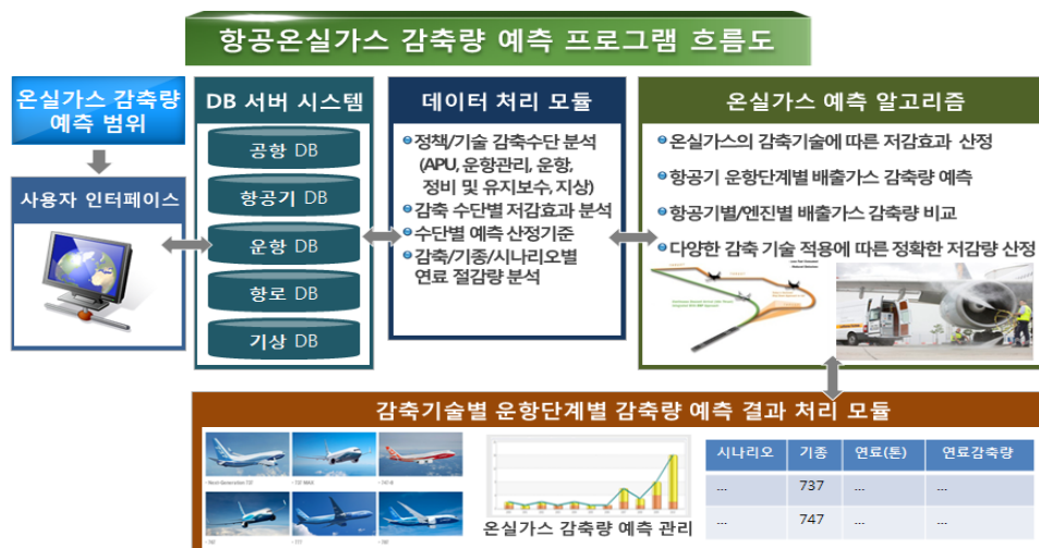
<그림76 > 항공 온실가스 감축량 예측 시스템 구성도
