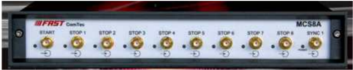
그림 5-12. 미세 먼지 라이다 시제품에 사용될 MCS8A 모델의 광 계수기
