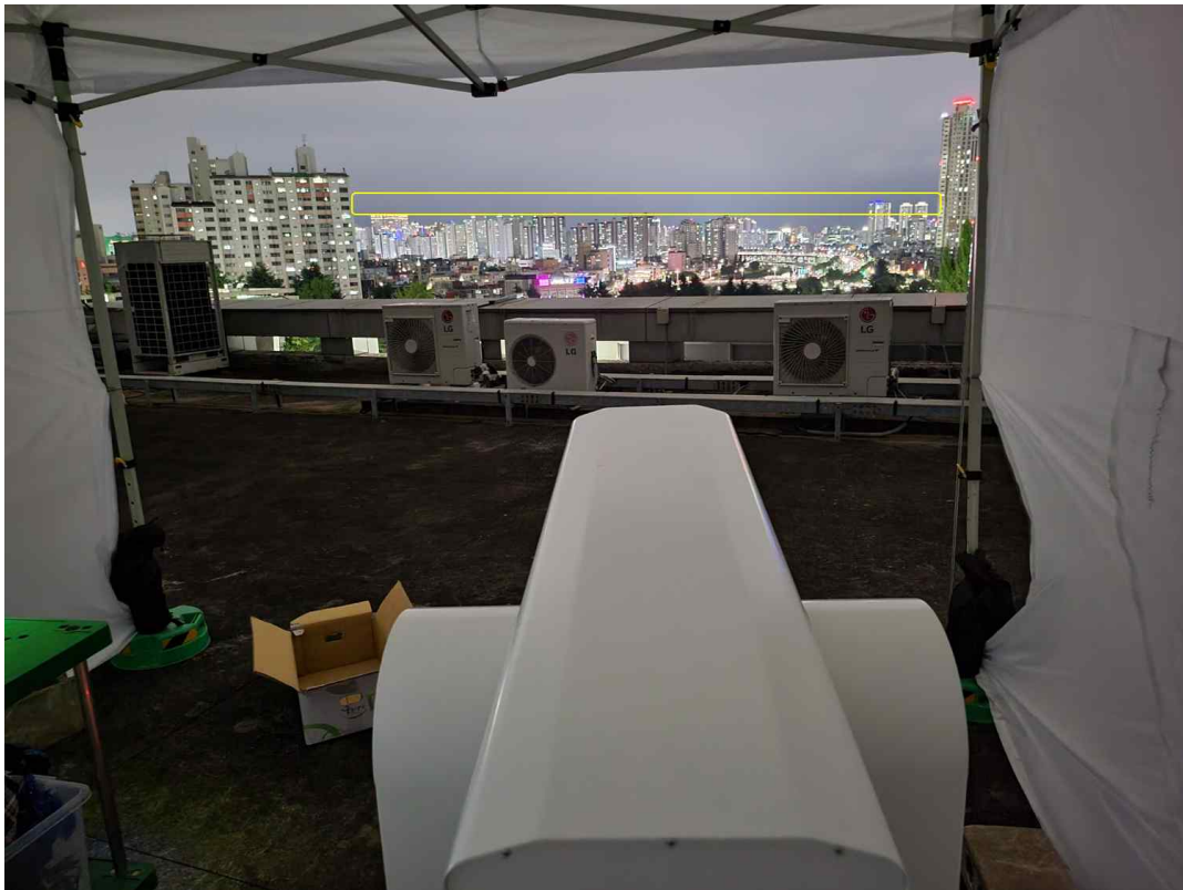
그림 5-61. 스캐닝 모터의 설정을 위한 관측 범위 설정
