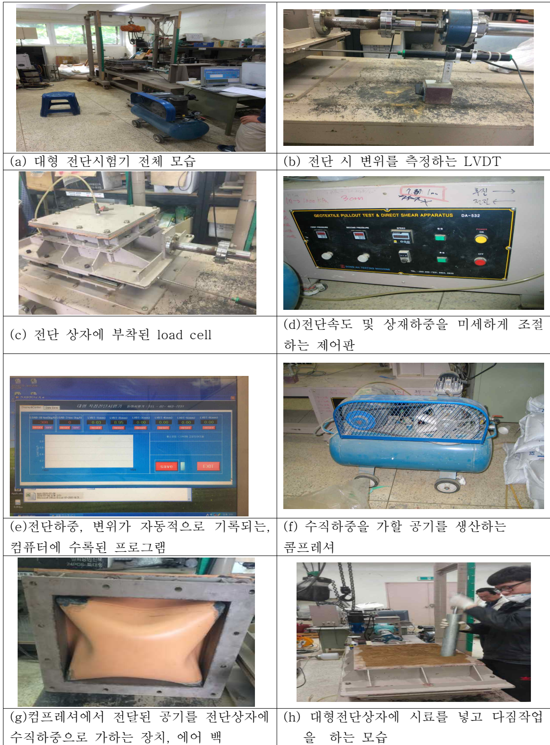
그림 3.7.1 대형 전단시험기에 의한 전단시험
