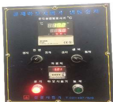
그림 3.3.3 마모시험기 회전 counting 컨트롤러 모습
