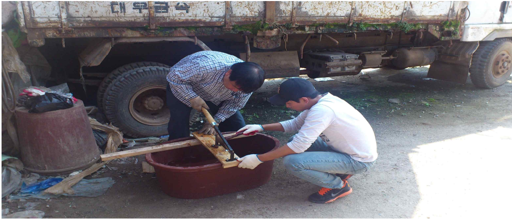
그림 3.2.2. 가래떡 모양의 용융된 폐비닐을 잘라 PE골재를 만드는 모습
