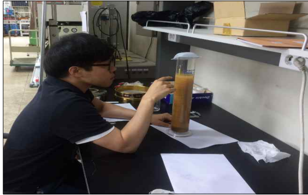
그림3.4.2 흡시료에 대한 비중계 시험 모습
