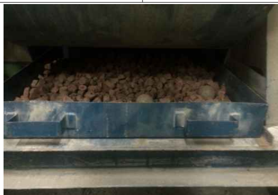
그림 3.3.5 500회 회전 후 PE골재를 꺼낸 모습
