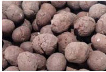
(a)석탄회를 이용한 경량골재 (b)혈암 및 점토를 이용한 경량골재
