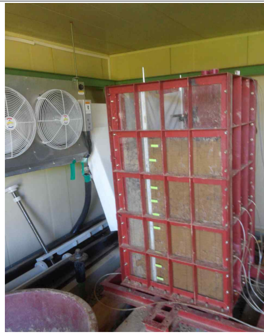
그림 3.9.9 냉동챔버 내에 거치된 모형토조와 뒷채움흙의 동상량 측정 LVDT
