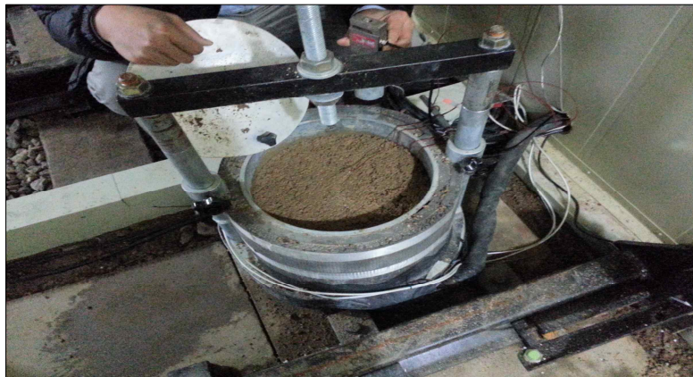
그림 3.10.11 동상력 측정 장치
