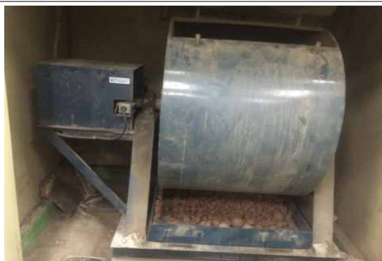
그림 3.3.4 마모시험 후 강구와 PE 골재
