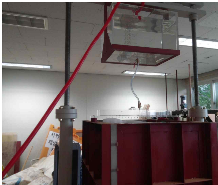
그림 3.9.6 모형 옹벽의 강우 재현 장치 사진
