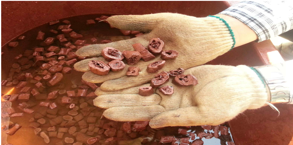
그림 3.2.3 공극이 다량 포함된 PE골재의 모습
