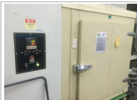
그림 3.3.1 KICT 보유 LA마모 시험기 (시험 중 소음 차단을 위해 box 속에 넣음)
