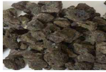
(a)석탄회를 이용한 경량골재 (b)혈암 및 점토를 이용한 경량골재
