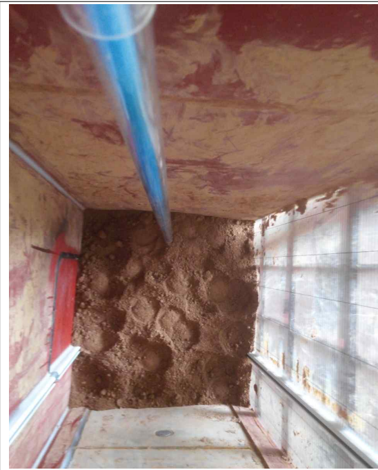
그림 3.9.8 모형토조 내 뒷채움흙의 동결깊이 측정용 methylene blue 동결심도계
