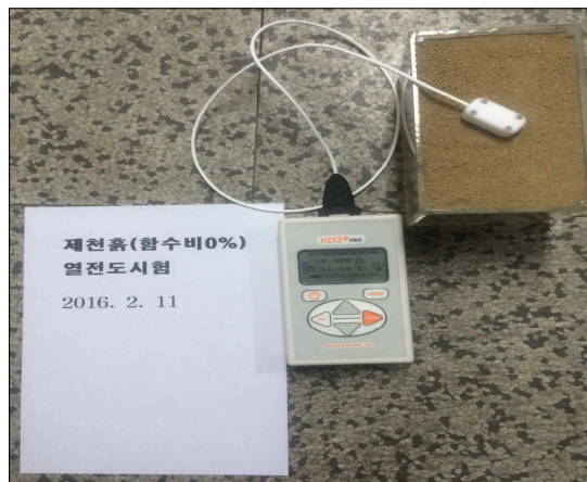
그림 3.8.2 제천 흙 시료 건조 시(함수비 0%) 열전도율 측정 모습
