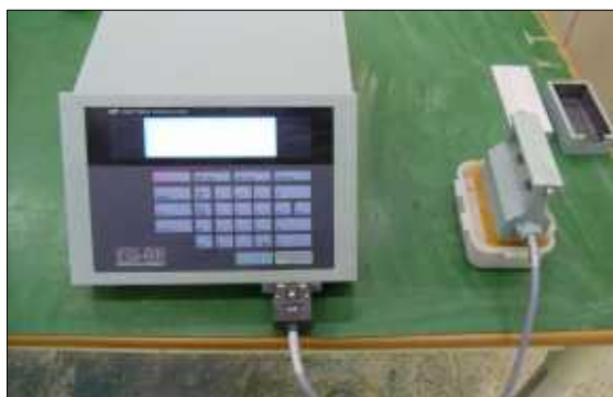
그림 3.10.4 열전도율시험기(QTM-500)의 모습과 프로브(Probe)의 구조
