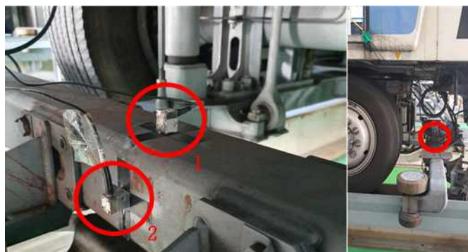
< 부산 4호선 진동가속도 현장계측 측정지점 (대차) >
