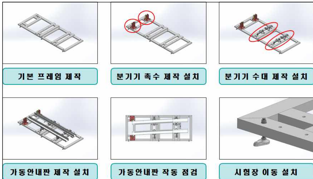
〈 실내성능검증 테스트 베드 제작 과정 〉
