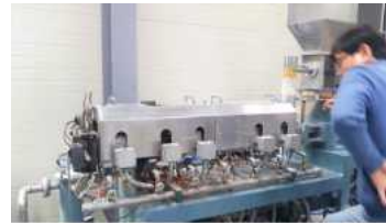
실험용 장비와 폴리머를 이용한 펠릿 제작 검증
