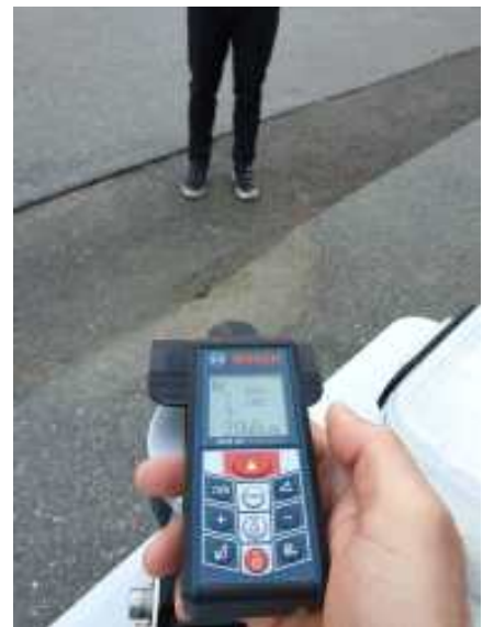
<센서융합 충돌 위험도 야외 실험 및 레이저 거리계 측정 비교>
