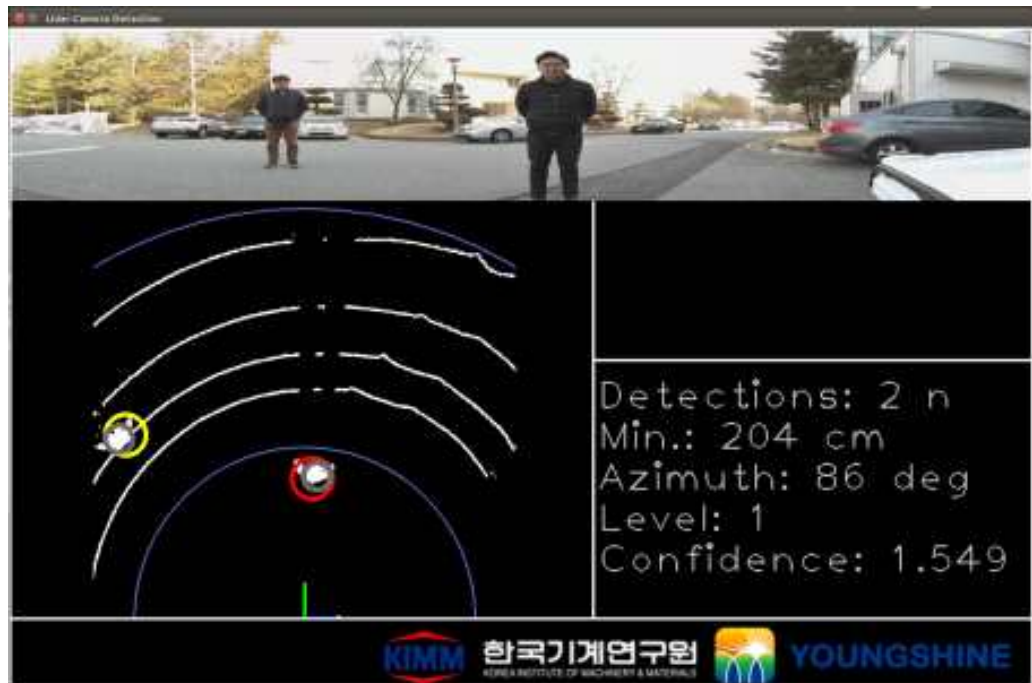
<LiDAR + 영상 기반 작업자 인식 실험 GUI>
