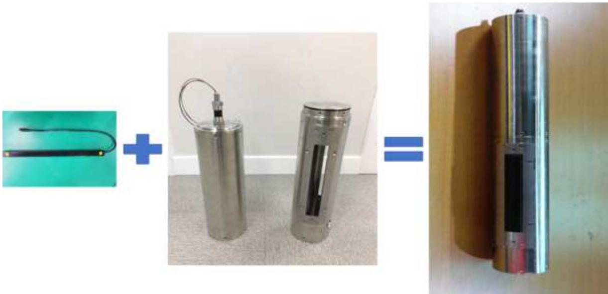
그림 3.1.9 2MHz Side Scan Sonar (Transducer array + Towfish Body)
