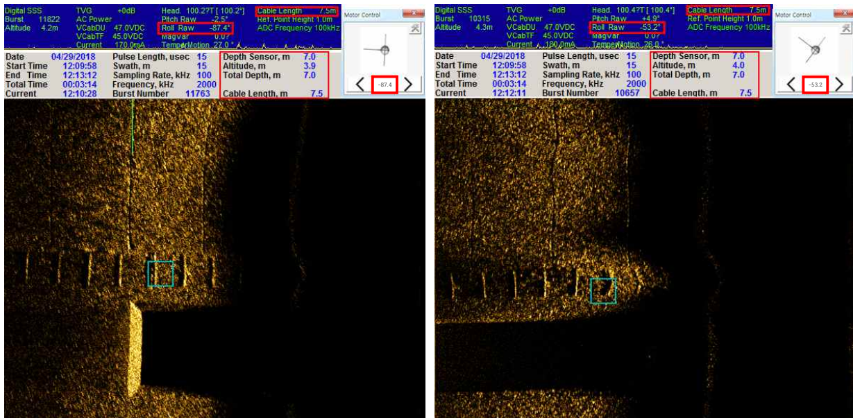
그림 3.2.24 항만시설 소나 초음파영상을 통한 제어각도 및 수심 확인
