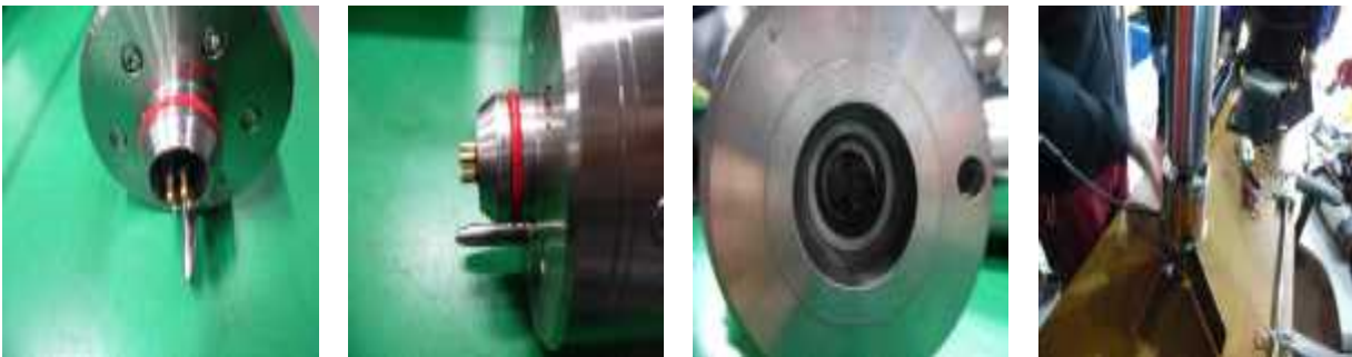
그림 3.2.13 컨넥터 고무패킹 및 전동지그 후미 제어부와 Towfish의 결합
