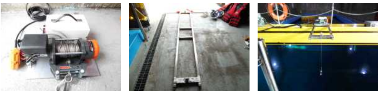
그림 3.2.11 수직 인양 전동 윈치(전동 윈치 및 거치 사다리)
