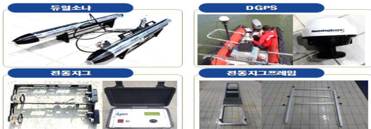
그림 3.2.2 기존 수중 점검용 듀얼 소나 장비의 구성
