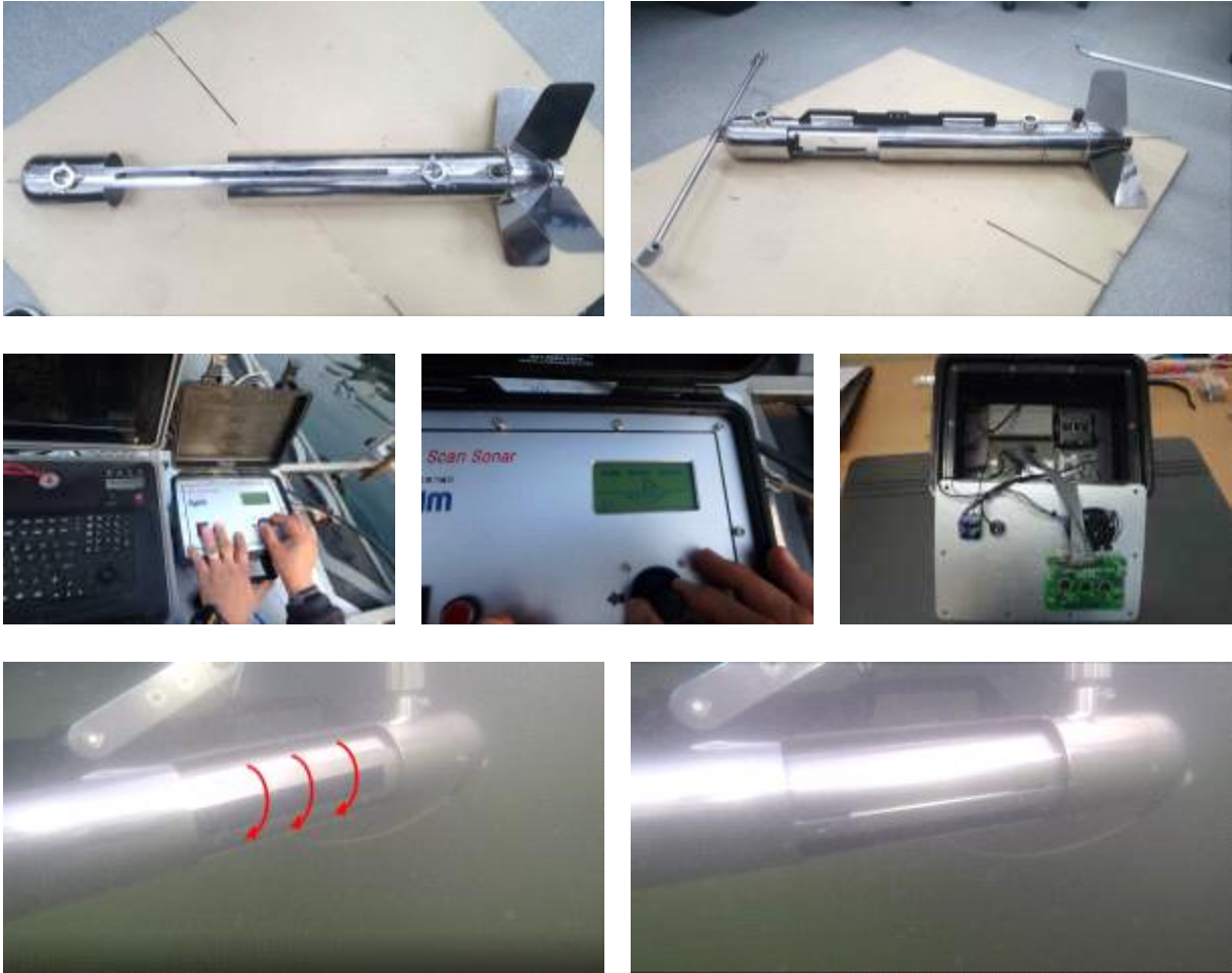
그림 3.2.10 전동지그 바디 및 전동지그 컨트롤 콘솔
