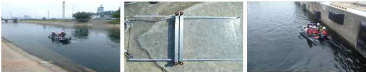
그림 3.2.20 Side Scan Sonar 수직 인양 속도 측정 (현장시험)
