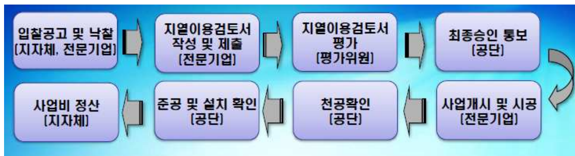
〈그림 3-3〉 지열 냉난방 시스템 설비 보급시장의 구조
