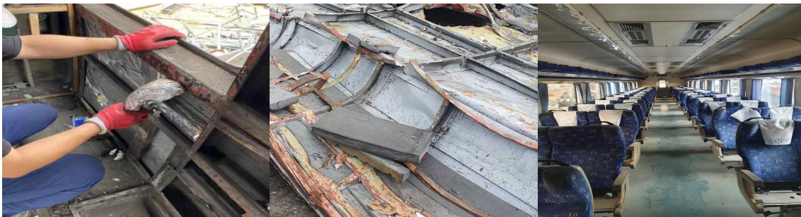
그림 55. 철도차량 해체 시 재활용이 가능하나 폐기되는 부품 예
