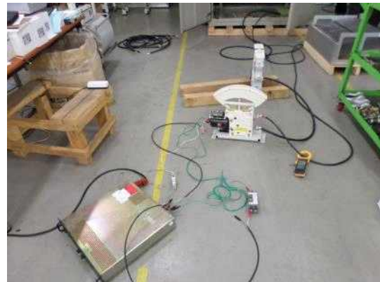
[그림 3-29] 전자접촉기 차단성능 시험
