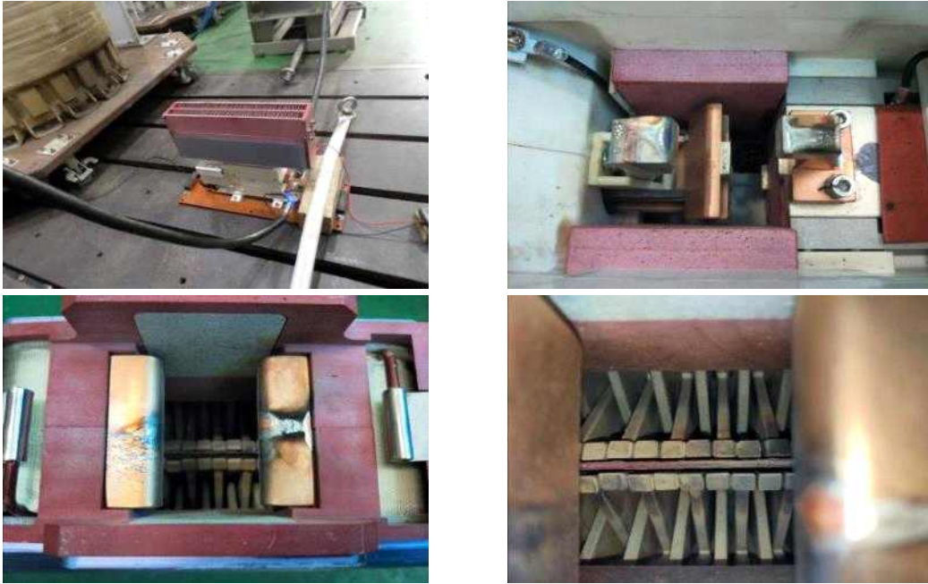
[그림 3-49] 더블 세라믹 + 더블 메탈형(#3) 차단시험
