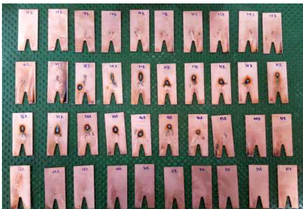
[그림 3-19] 차단시험 후 대칭형 아크 그리드
