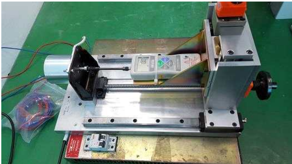
[그림 3-3] 전자코일의 전자력 측정 사진
