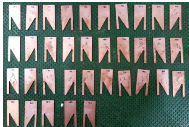
[그림 3-20] 차단시험 후 비대칭형 아크 그리드
