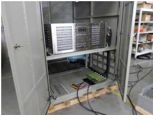
[그림 3-29] 전자접촉기 차단성능 시험
