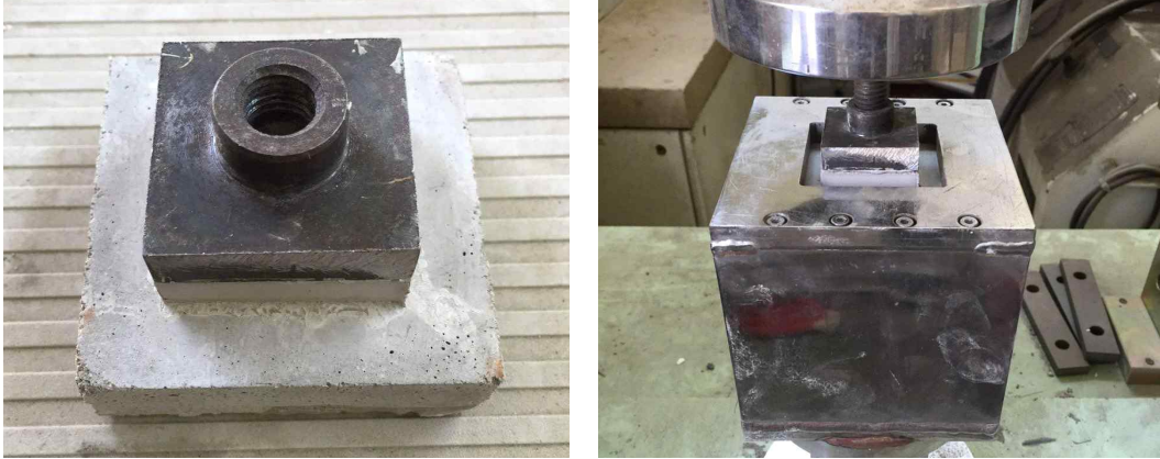
그림 3.26 부착강도 시험 전경
