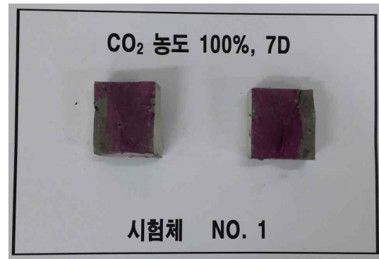
(b) 탄산화 깊이 측정
