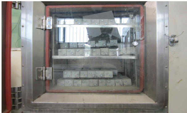
그림 3.80 철근부식 촉진 Cycle(항온항습챔버)
