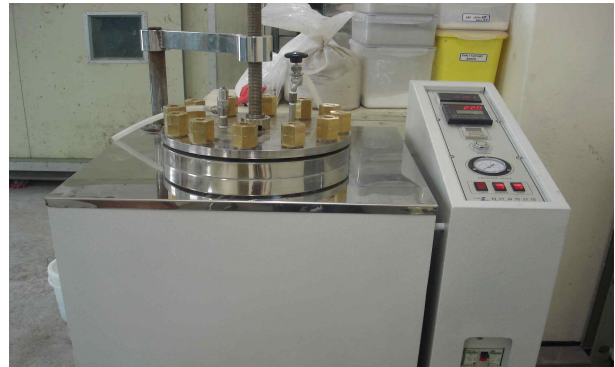
그림 3.79 고온고습 부식촉진 모습(오토클레이브)
