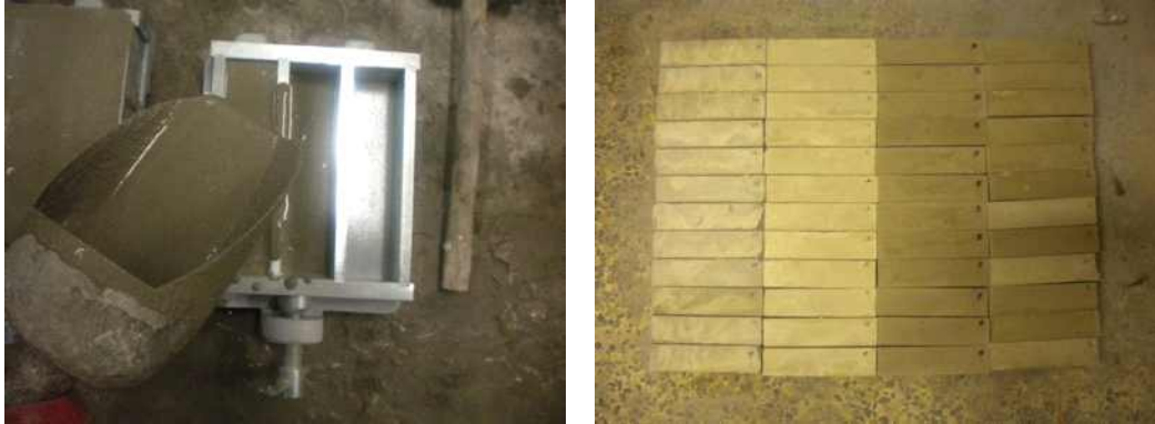
그림 3.20 휨/압축강도 시험체 제조 및 시험체 전경
