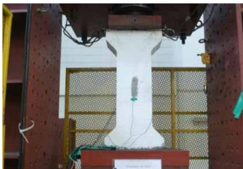
<중심 압축 실험체 설치>
