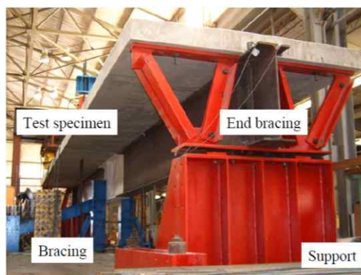
<Full-scale beam test 실험체 설치 예>
