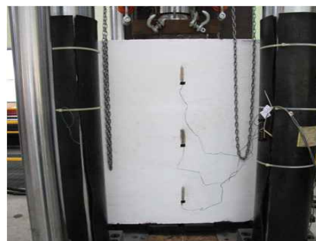
<콘크리트 변형률 게이지 설치>
