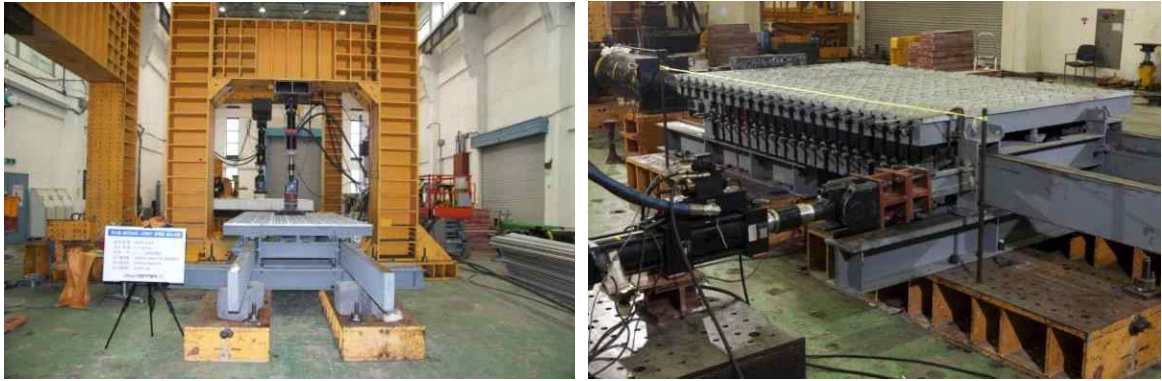
<신축이음 성능평가를 위한 실험체 설치 전경>
