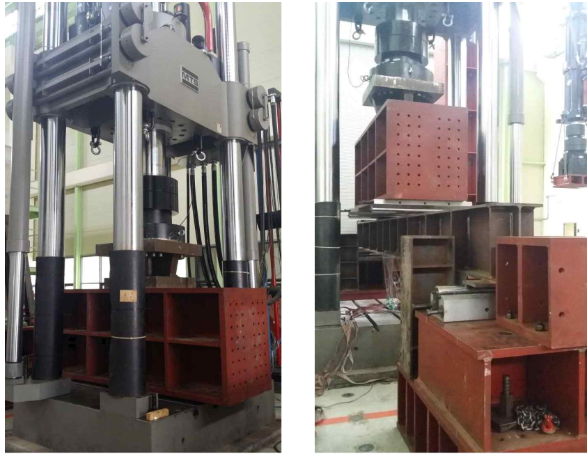
<UTM, 재하용 가력보 및 지점 설치>
