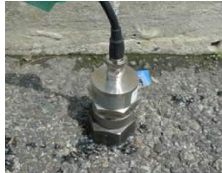
<가속도계 설치 (예: 교량의 바닥판 상부에 설치)>
