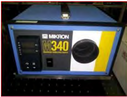
✶ Blackbody calibration source - 온도 설정에 맞는 적외선 열원 발생 - Temperature Range : -20°C~150°C - Accuracy : ± 0.3°C
