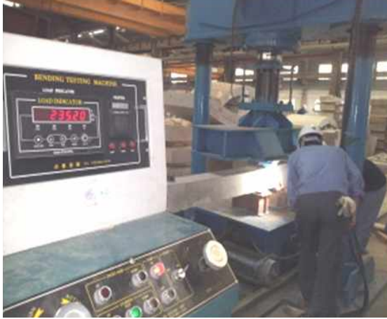
[레일직하부 휨강도 균열 시험_좌]
