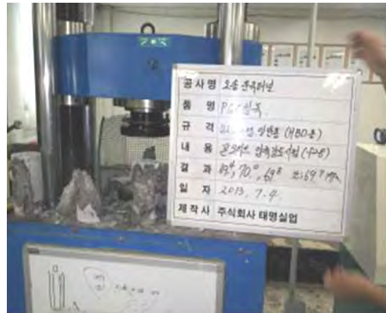
[콘크리트 압축강도 시험]
