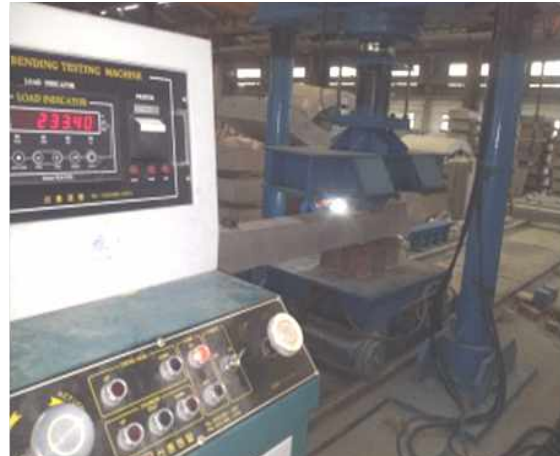
[레일직하부 휨강도 균열 시험_우]
