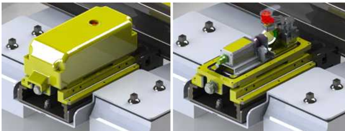
그림 26 3D 설계 형상(진동감소를 위한 침목체결형)
