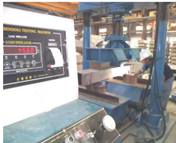
[레일중앙부 휨강도 균열 시험_우]
