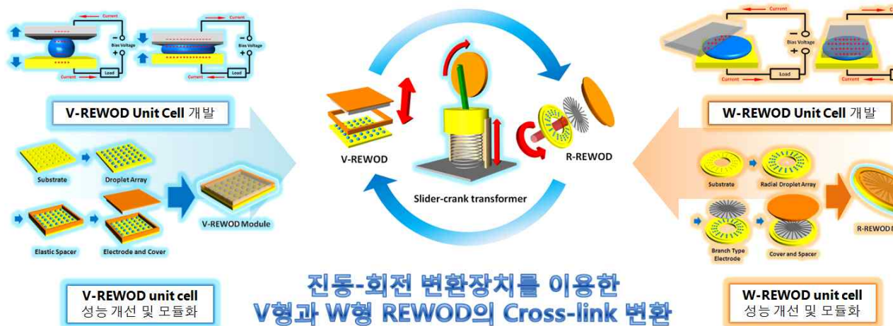
<그림 30. 진동 환경에 국한되지 않는 V-REWOD / R-REWOD 의 연계 모듈>
