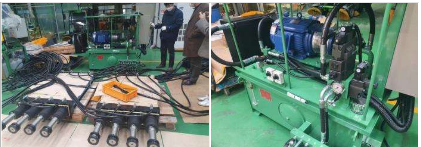
그림 98. 슬립폼 작업 시스템 제작, 8연동 유압 실린더 및 유압 유닛 시제품 전경
