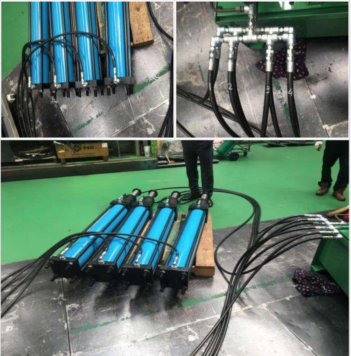
그림 59. 유압 실린더 및 유압 유니트(동조화 펌프) 완료
