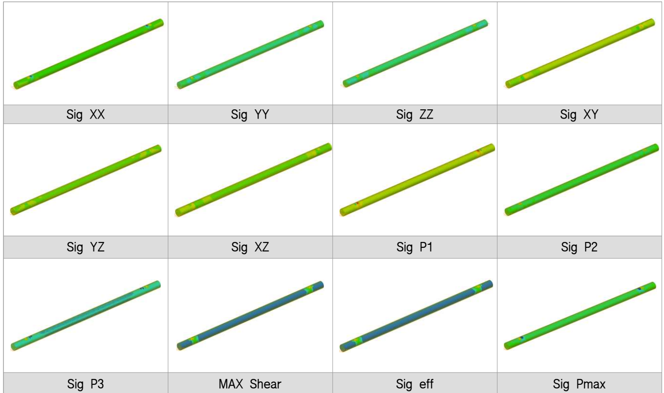
그림 55. 해석결과 응력 전개도
