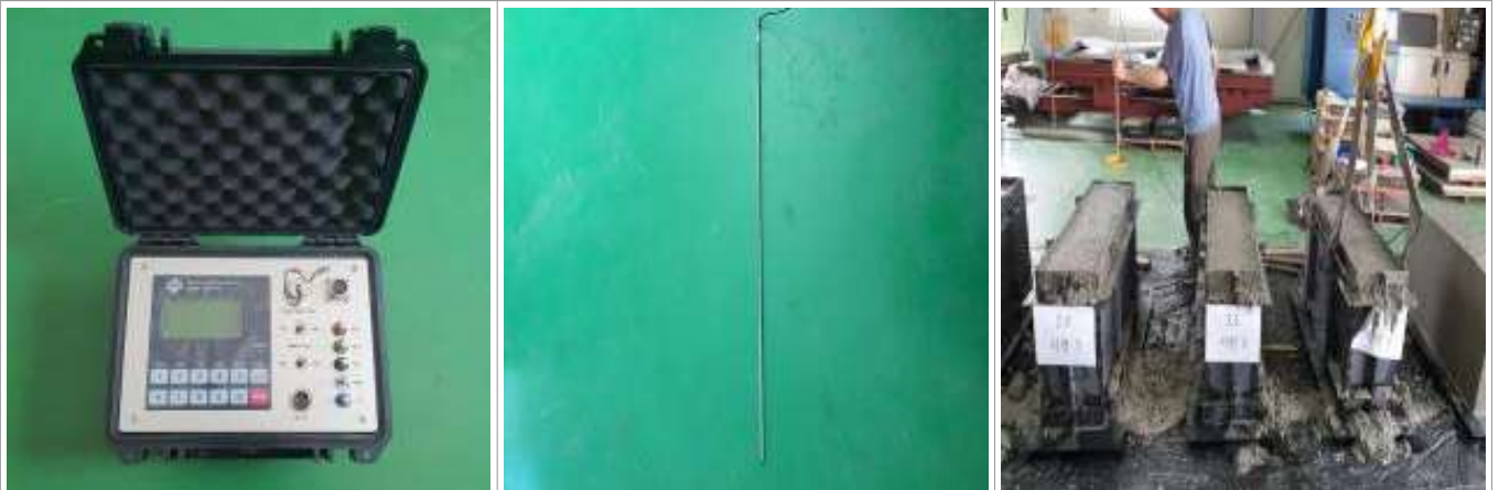
그림 71. 콘크리트 양생확인용 탐침 측정 장비 및 측정 전경
