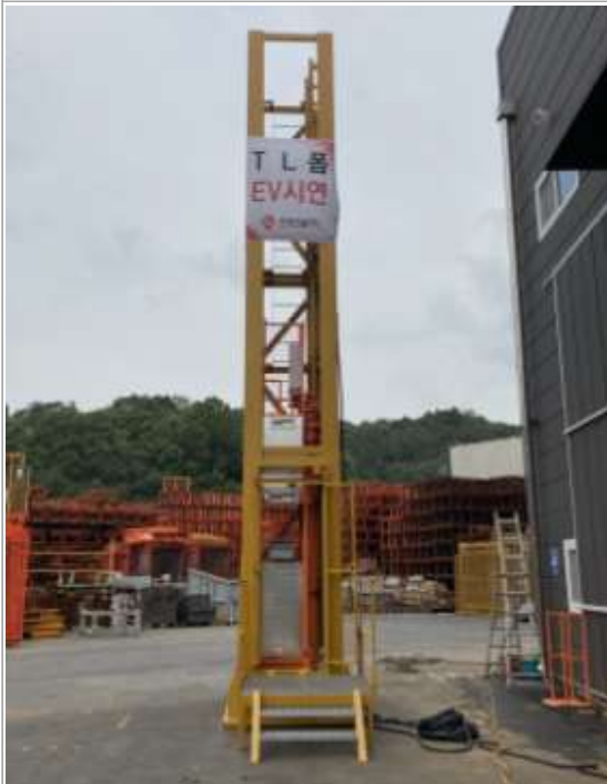
그림 79. 시운전 전경 (타워 내부 엘리베이터)
