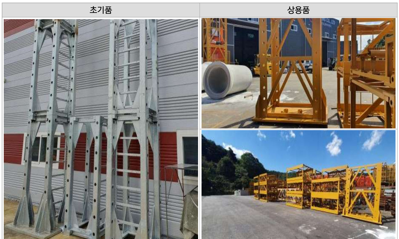
그림 49. 타워 마스트 초기품 및 상용품 전경
