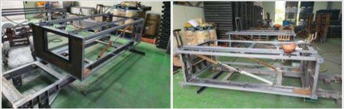
그림 40. 제작중인 타워 내부 인화물 호이스트 (타워내부 엘리베이터)
