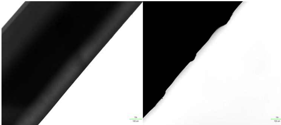
[그림 2-25] 광학현미경으로 관찰한 결과 좌) PLA spacer, 우)CNT-PLA spacer
