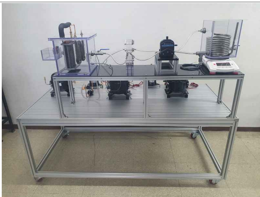
[그림2-57] 프로토 타입의 분리막 제습시스템
