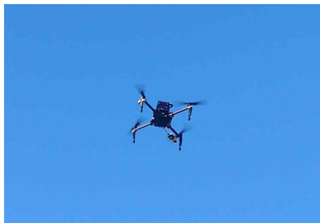
[그림 92] 프로펠러 후류의 풍속 측정 비행
