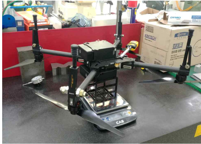
[그림 89] 비행체의 총무게 측정
