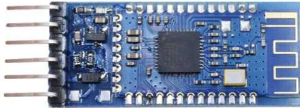
[그림 114] 블루투스 모듈(HM-10 Bluetooth 4 BLE Modules)
