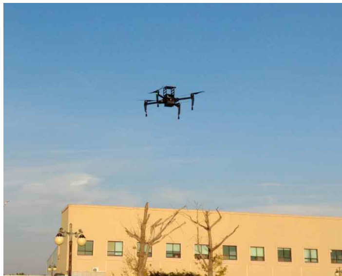
[그림 85] M100 초도비행(조립 후, 안정성 검사)
