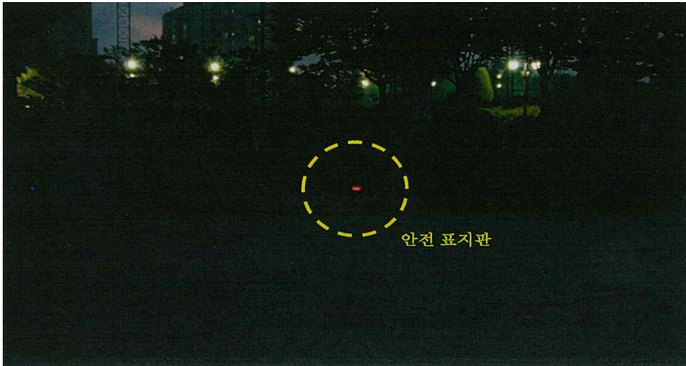
<그림 3.25> 야간 시인성 시험 사진(셔터 스피드 : 1/60, 조리개:F4.5, ISO :400)
