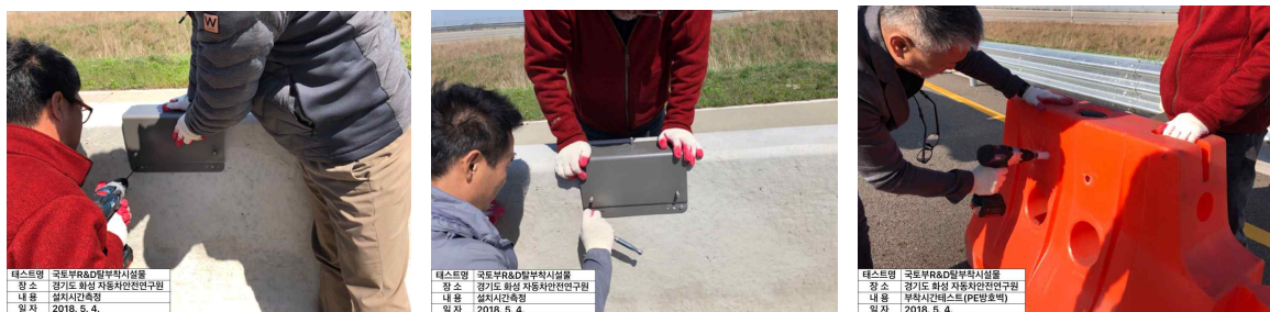
<그림 3.38> 탈부착시설물 설치·해체시간 및 난이도 테스트 사진
