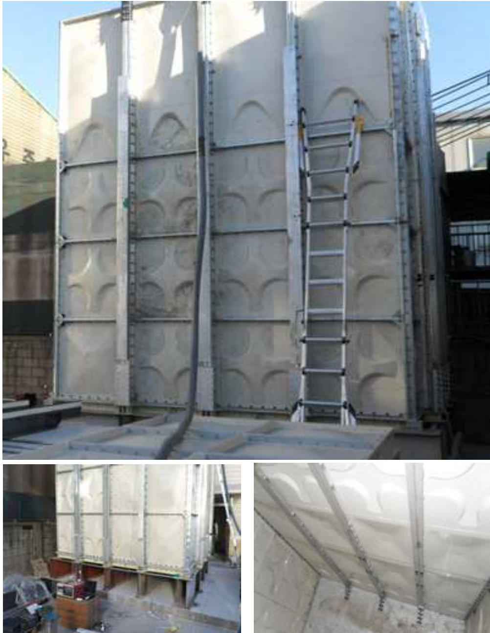
그림 2.10 5m 물탱크 담수재하실험
