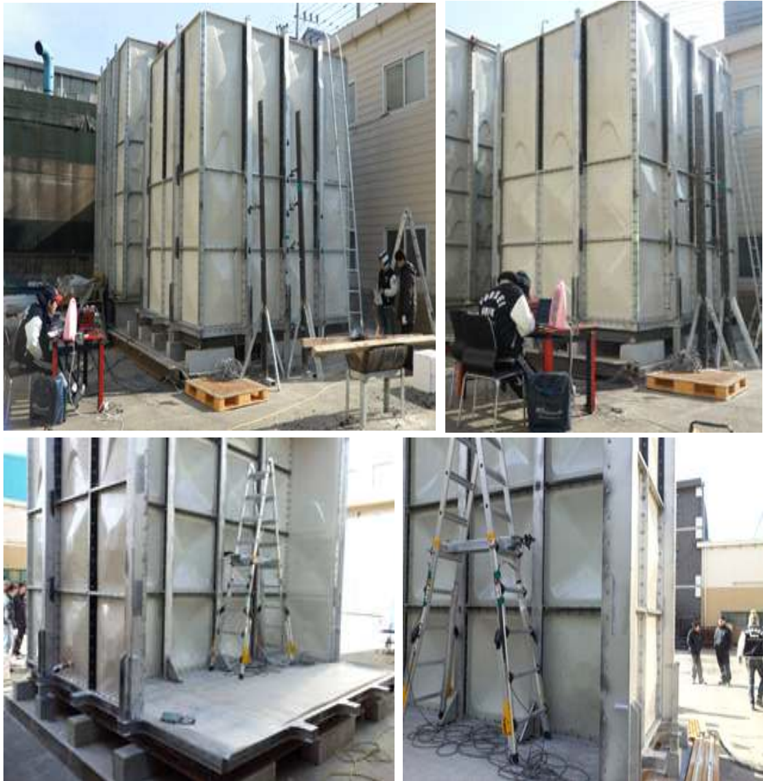
그림 2.17 4m 물탱크 담수재하실험
