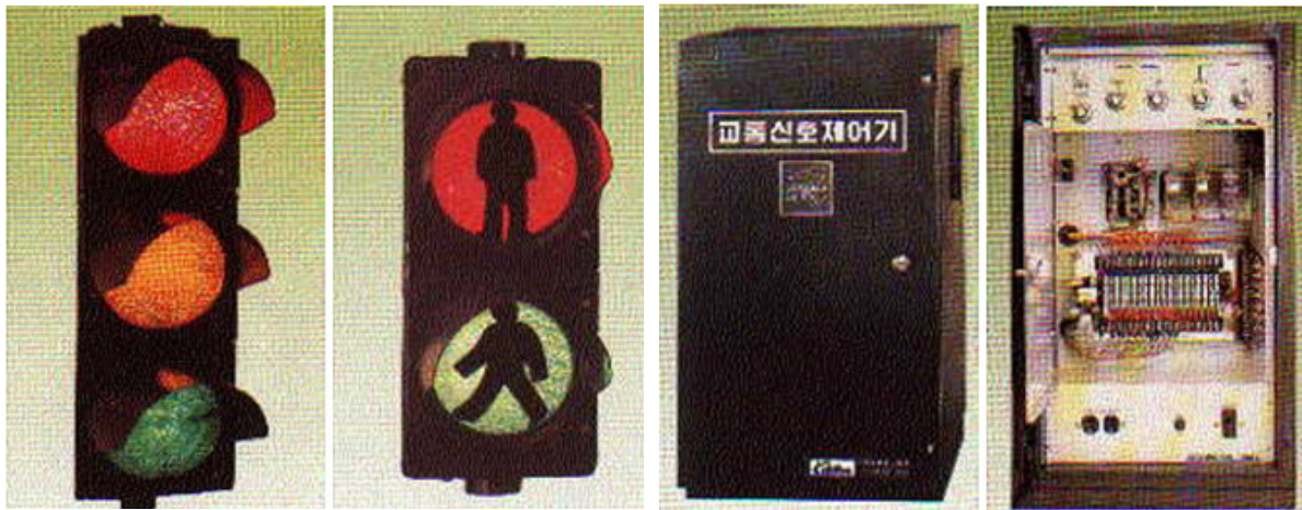
그림.2- 30 우리나라 최초의 플라스틱 신호등과 Drum switch를 이용한 신호제어기
