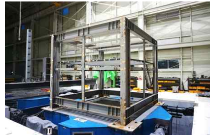
실험대상품 진동대 설치(2/2)
