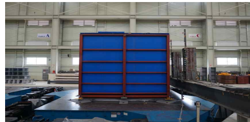
실험대상품 진동대 설치
