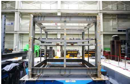
실험대상품 진동대 설치(1/2)
