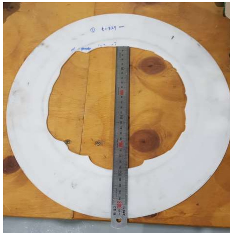
그림 3.23 충돌실험 후 3.3T 다이어프램
