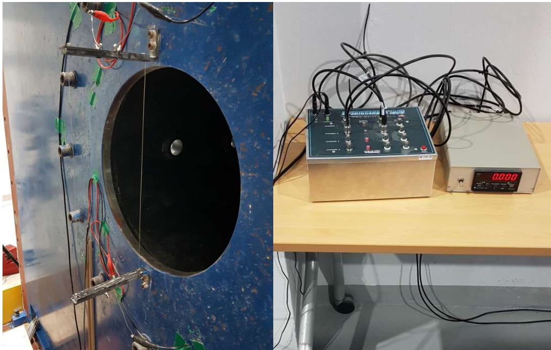
그림 3.31 Wire breaking system
