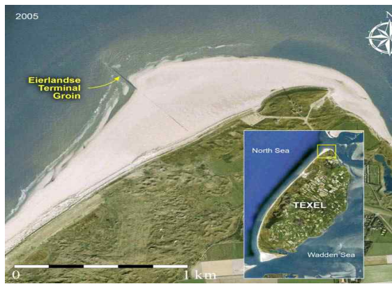
(a) 돌제(Groin)을 이용한 해안저감방식】
