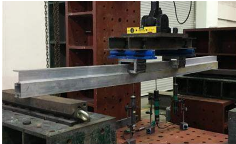
<그림 3.4> drop형 보팀버 빔의 휨 파괴실험 전경
