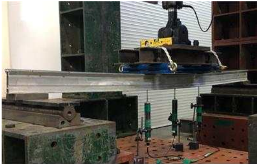
<그림 3.1> drop형 받침대 빔의 휨 파괴실험 전경
