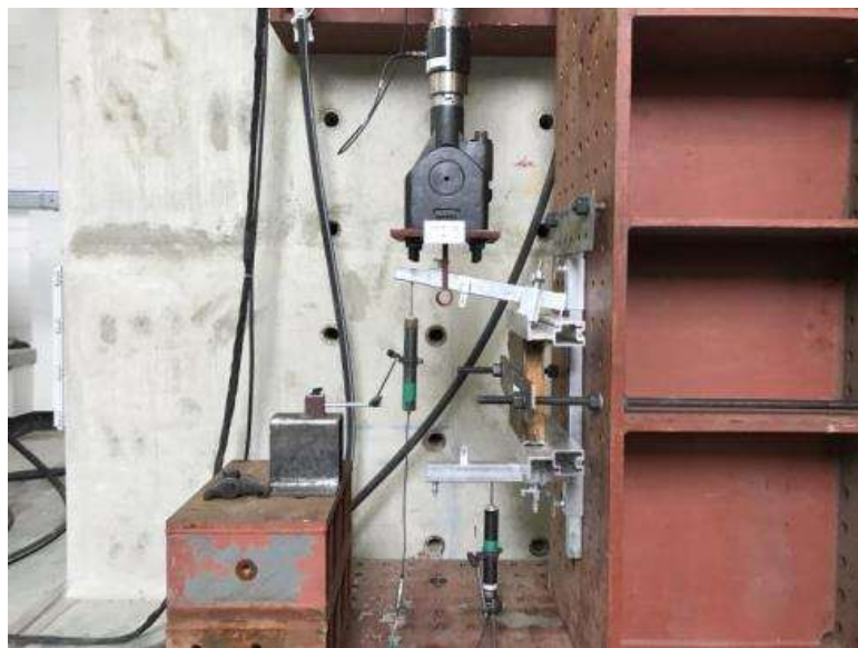
<그림 3.12> 보 브라켓의 파괴실험 전경
