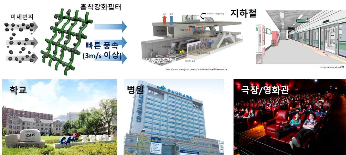
그림11. 흡착강화 필터를 이용한 고속집진 모식도와 적용 대상 시설
