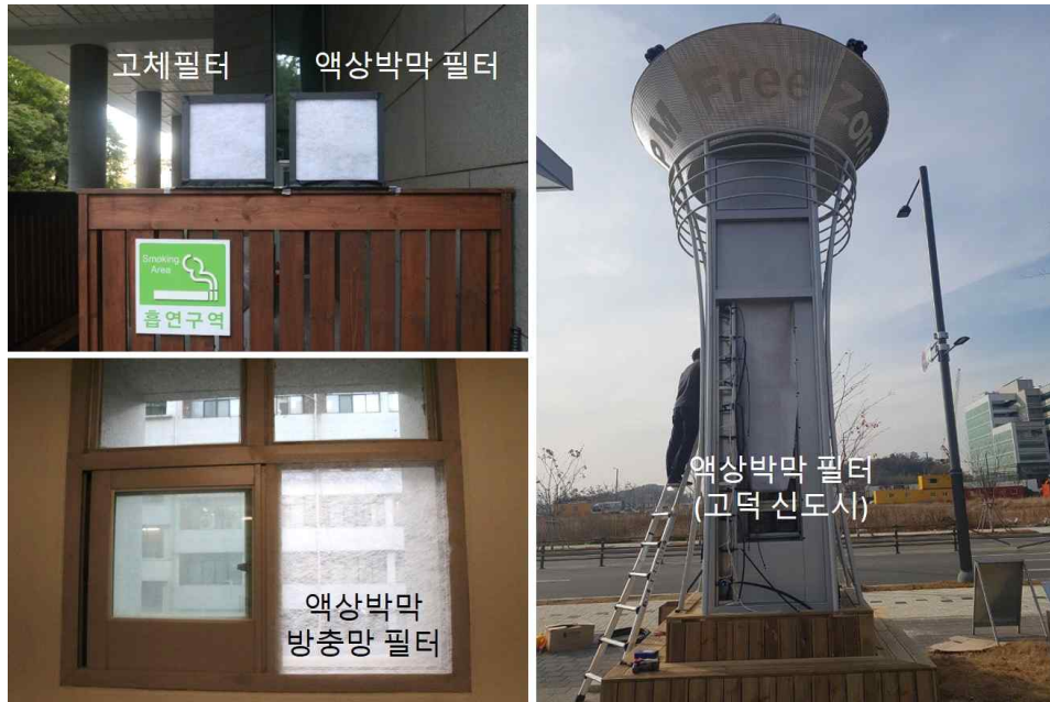
그림 10. 액상막 필터를 이용한 자연풍 집진, 방충망 집진 및 대형 공기청정기용 필터로의 적용
