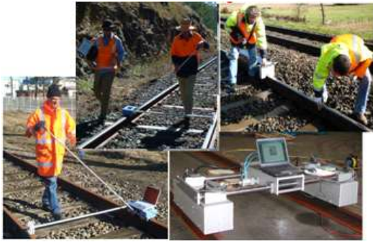
그림 34. 레일의 음향조도 측정 및 레일의 거칠기 측정과 관리로 인한 소음 및 진동 저감
