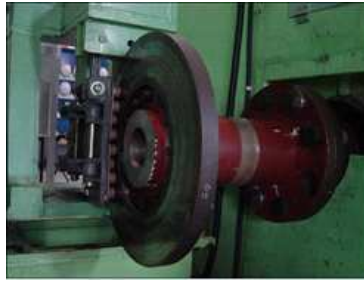
철도차량용 제동디스크 답면에서의 마찰계수 측정 실험 예
