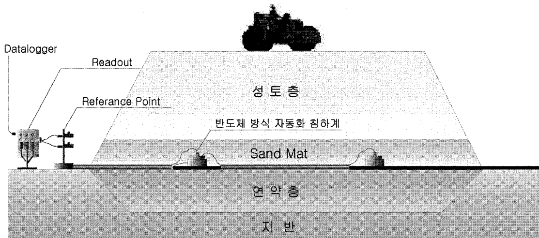
<그림 3.2> 반도체방식 침하계의 설치단면도
