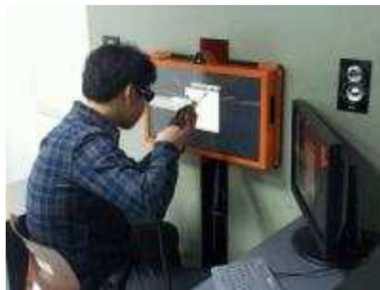
그림 1-8. 가상 용접 훈련 시뮬레이터 (토탈소프트뱅크)
