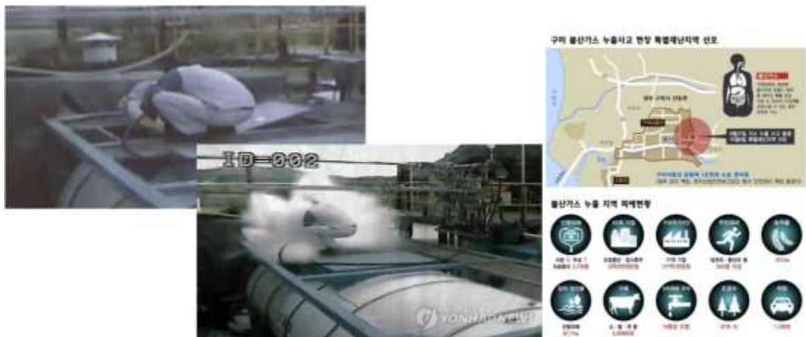
그림 1-2. 플랜트 조업자 훈련 미비로 인한 불산 가스 누출 사고 (구미 공단, 2012. 9. 27)
