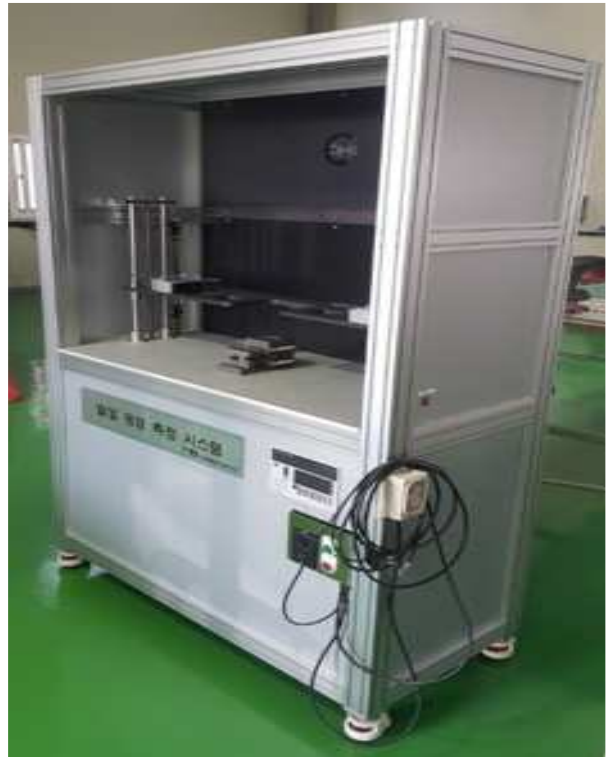
그림 2-2 팽창력 측정 장비 지그
