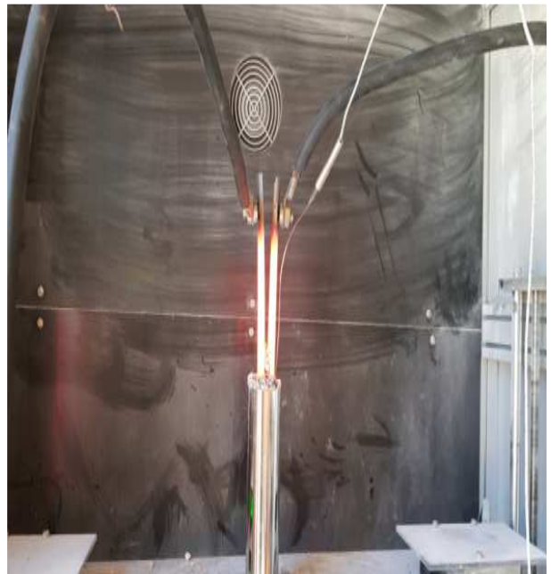
그림 2-45 모델 2 - 발열체 형상 및 가열 테스트
