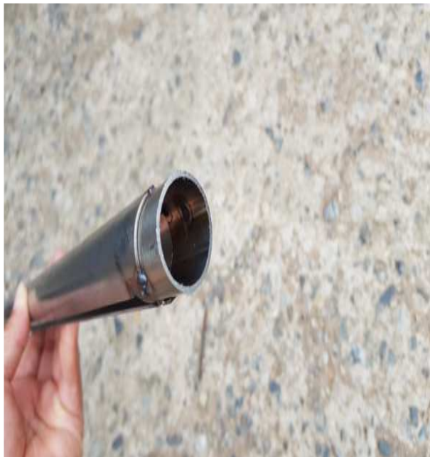
그림 2-45 모델 2 - 발열체 형상 및 가열 테스트
