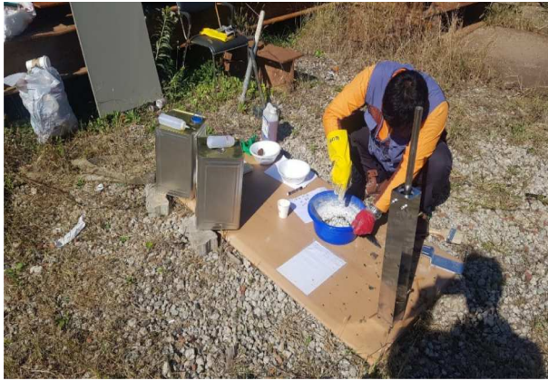
그림 2-21 하우징 재료 혼합 및 지그에 투입
