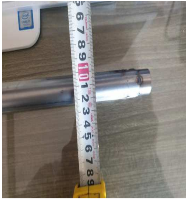
그림 2-44 모델 2 - 발열체 치수 및 형상
