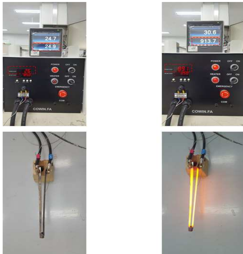
그림 2-114 제어보드 온도 테스트 확인
