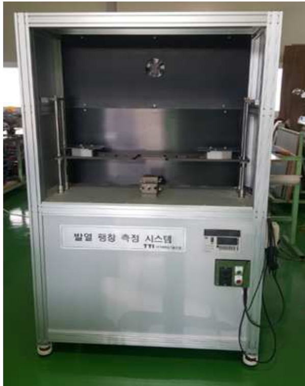
그림 2-2 팽창력 측정 장비 지그
