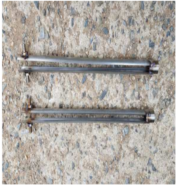
그림 2-44 모델 2 - 발열체 치수 및 형상
