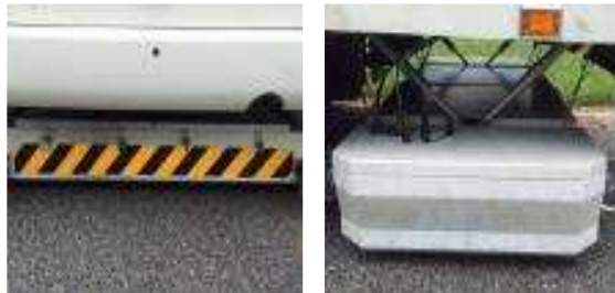
(b) GPR 안테나 박스 후면 (c) GPR 안테나 박스 측면
