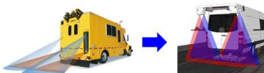
<소성변형계측기의 대각조사로 인한 위치 편차 제거 및 노면모듈 일체화>
