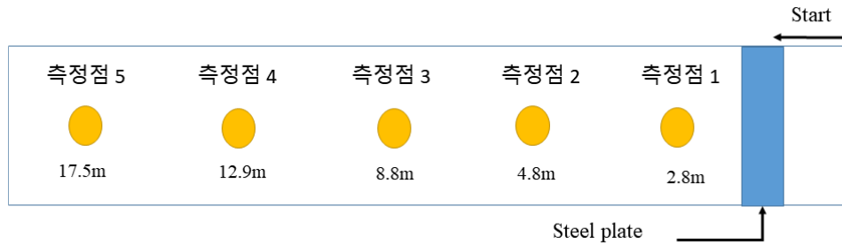
<2차 현장 GPR 조사 및 코어채취>
