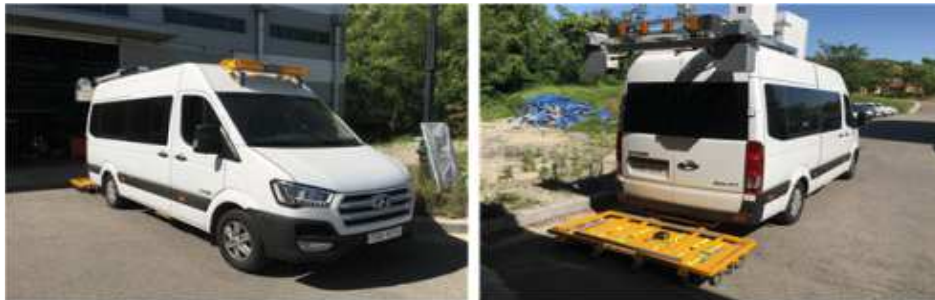
<개발 완료된 도로함몰 복합탐지 시스템 전경>
