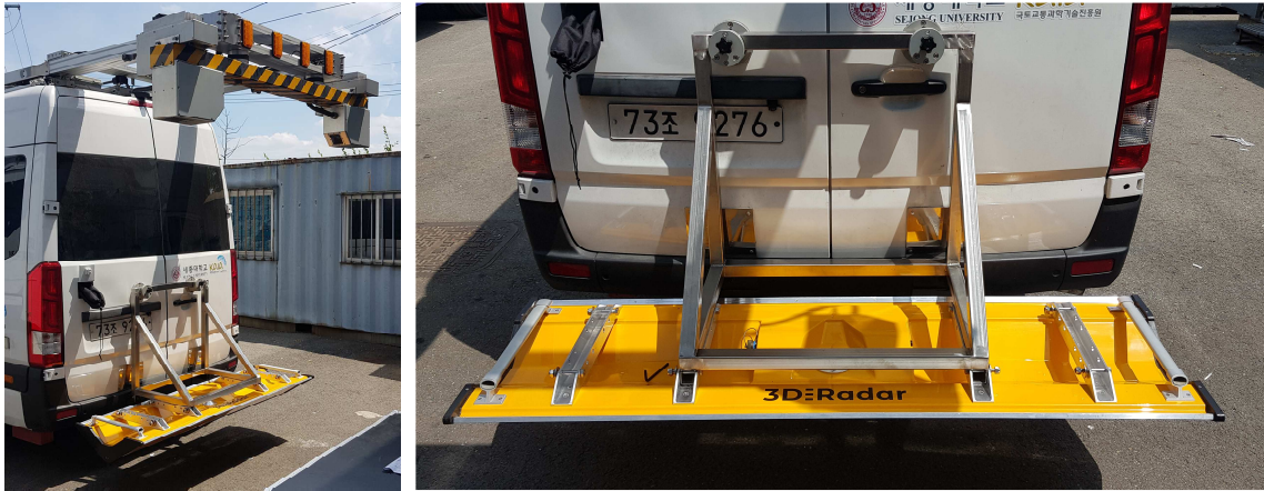
<비접촉식 3D GPR 차량 탑재 치구 제작>
