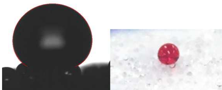
그림 92. 직접 제작한 샘플의 물에 대한 접촉각 측정과 붉은 색 염료가 포함된 물방울을 샘플 표면 위에 떨어뜨렸을 때의 실제 사진.
