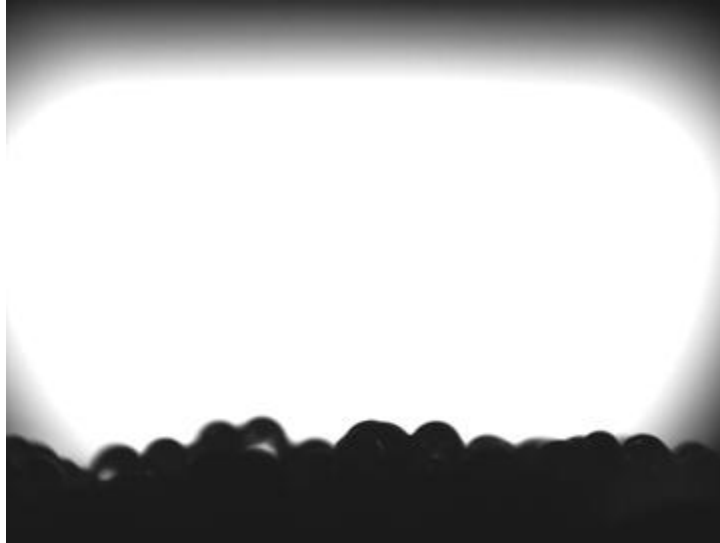
그림 89. HF를 이용하여 표면의 거칠기만을 증가시킨 글라스비드와 도료 표지용 도료와의 혼합을 통해서 만든 샘플위에 물방울을 떨어뜨렸을 때의 광학 현미경 사진.
