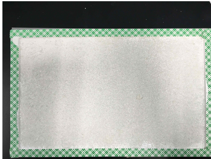
그림 91. 크기 20cm X 30 cm 로 제작된 샘플. 가장 자리에는 페인트를 높이 도포하기 위해서 양면테이프를 이용하여 틀을 붙여서 만듦.
