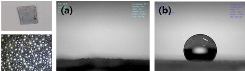
그림 78. Drop casting 및 spin coating (700 rpm)을 통해 분산시킨 글라스 비드 표면 위에서의 물방울 접촉각: (a) 일반 글라스 비드 (b) 소수성 글라스 비드.
