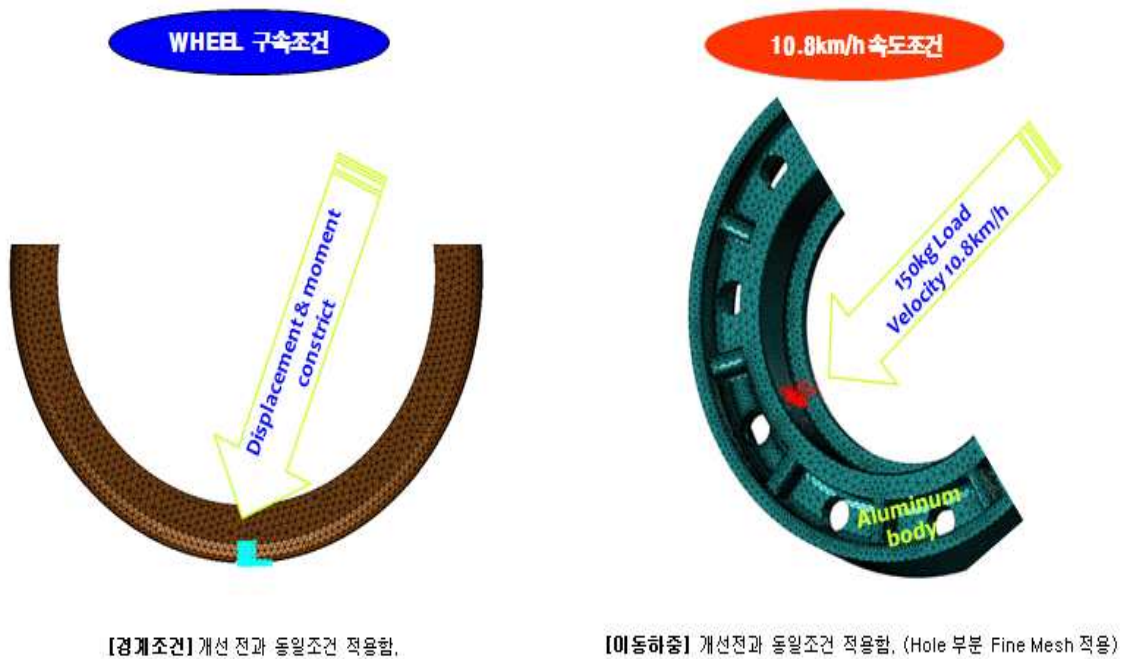
<그림 16> Wheel \varnothing 90 \times \varnothing 70 \times 20 Boundary 및 하중 조건
