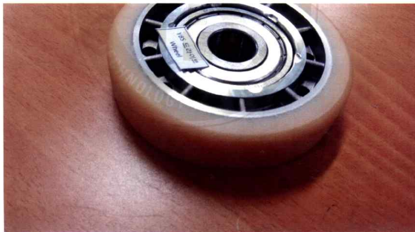
[그림 10] YBS 드라이브 Wheel 시험 종료 후 시편 사진
