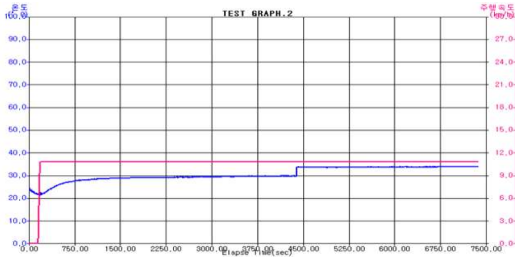
<그림 59> 자사 가이드 휠[Vulkollan(사출)] 하중 : 80kg, 속도 : 10.8km/h 2h 연속 구동 시
