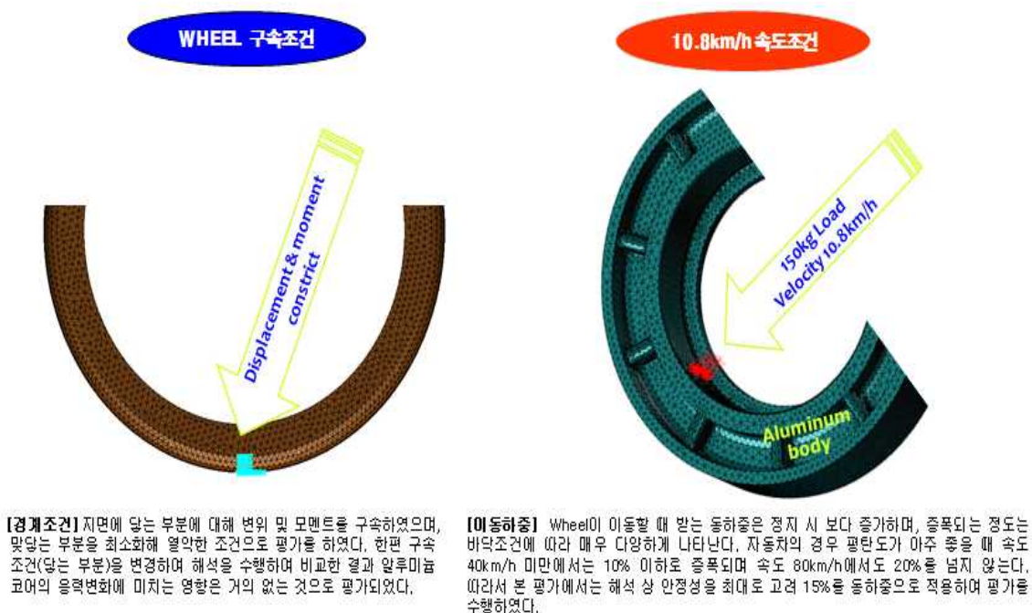
<그림 14> 개선전 Wheel Ø90xØ70x20 Boundary 및 하중 조건
