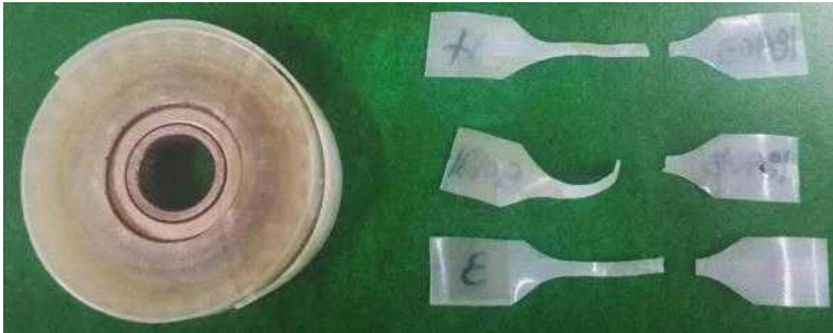
<그림 11> 타사 가이드 휠 Test 후 시편
