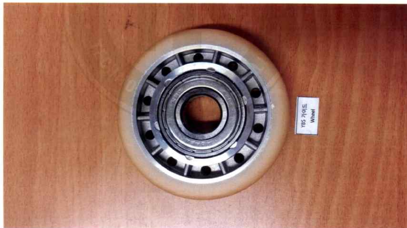
[그림 14] YBS 가이드 Wheel 시험 종료 후 시편 사진
