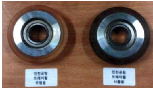
<그림 36> 자사 Test 휠[Vulkollan(사출)-우] (트레이 휠)
