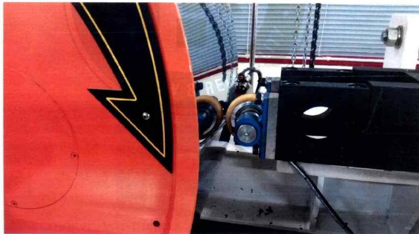
[그림 10] YBS 트레이 주형 휠 구동 시험 장면
