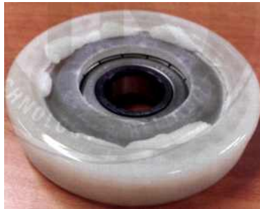
<그림 49> Test 후 타사 가이드 휠
