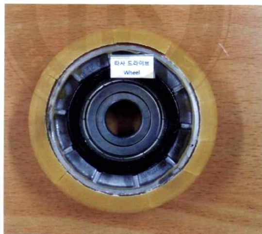
[그림 18] 타사 드라이브 Wheel 시험 종료 후 시편 사진
