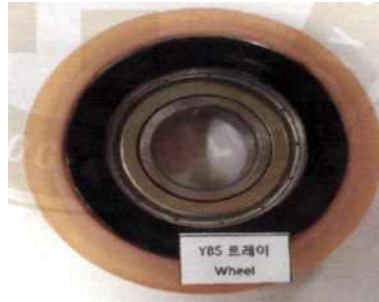
<그림 58> Test 후 자사 트레이 휠 [Vulkollan(주형)]
