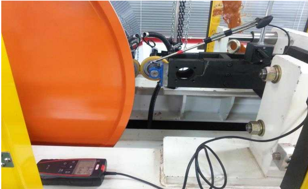
<그림 24> Wheel 구동 Test 시 풍속계 설치
