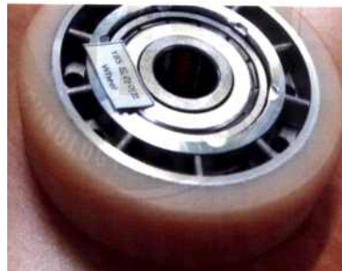
<그림 46> Test 전 자사 드라이브 휠 [Vulkollan(주형)]
