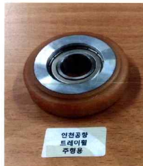
[그림 9] YBS 트레이 주형 휠 구동 시험시료
