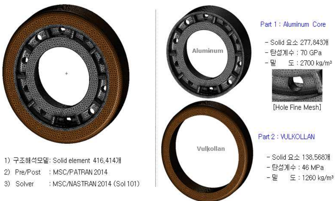
<그림 15> 개선 후 Wheel Ø90xØ70x20 요소망 생성
