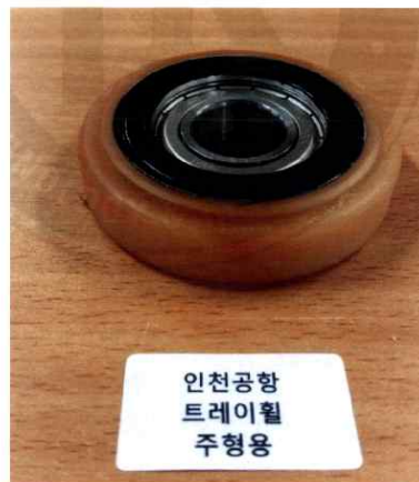
[그림 12] YBS 트레이 주형 휠 구동 시험 종료 후 시편 사진
