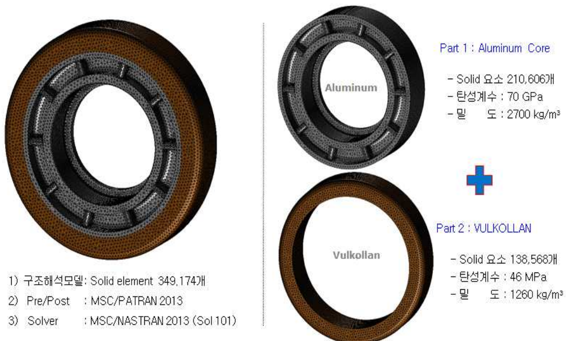
<그림 13> 개선전 Wheel \varnothing 90 \times \varnothing 70 \times 20 요소망 생성
