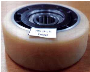
<그림 51> Test 전 자사 가이드 휠 [Vulkollan(주형)]
