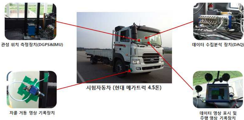
<차선이탈경고장치 양산품 장착자동차 평가를 위한 시험장비 구성>
