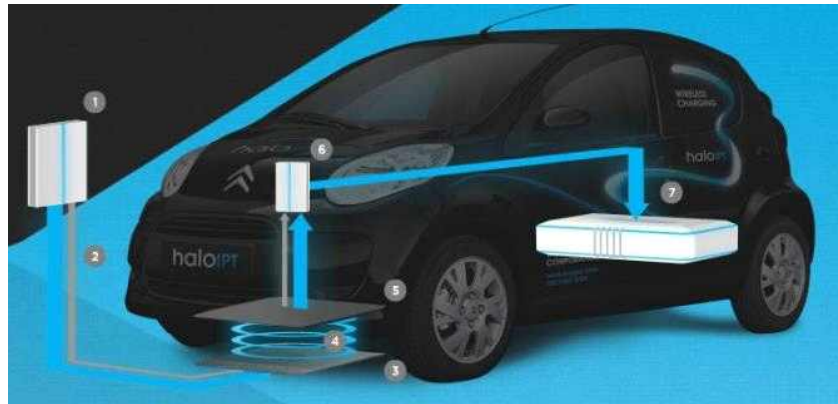
<유도 코일을 이용한 차량의 무선 충전 시스템>
