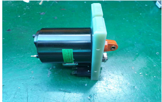
[ 그림 1 ] 소형 경량의 고속도차단기 저 유지전류형 전자코일
