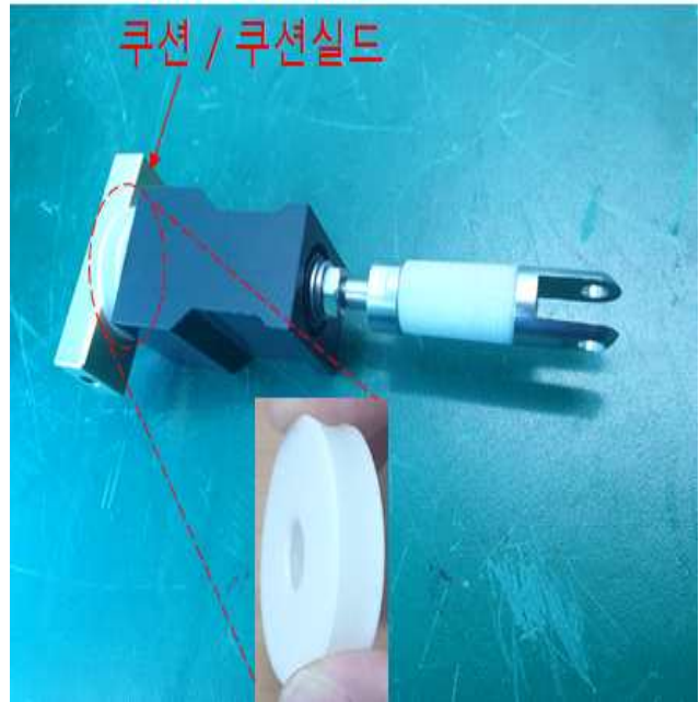
블랙박스 내장형 고속도차단기 S/W OPERATOR PART
