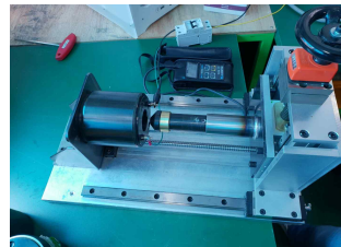
고속도차단기 전자코일 자기장 측정 사진
