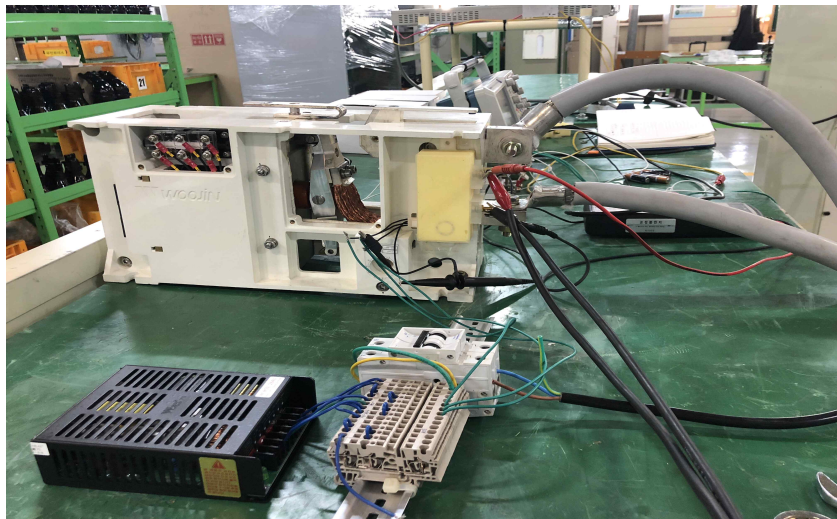
[ 그림 3 ] DC-VT 실제 운용 조건 가정 시험 사진
