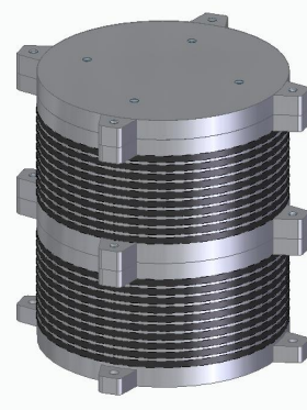
그림 21 면진장치의 단면도 그림 22 면진장치의 입면도 그림 23 그림 23 제작된 RFB 실험체 전경
