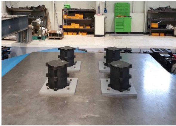
(a) 먼진장치 설치
