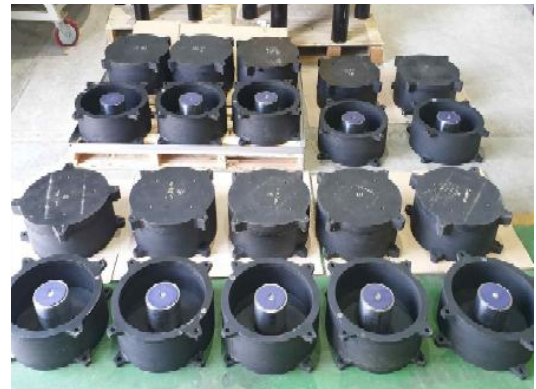
그림 21 면진장치의 단면도 그림 22 면진장치의 입면도 그림 23 그림 23 제작된 RFB 실험체 전경
