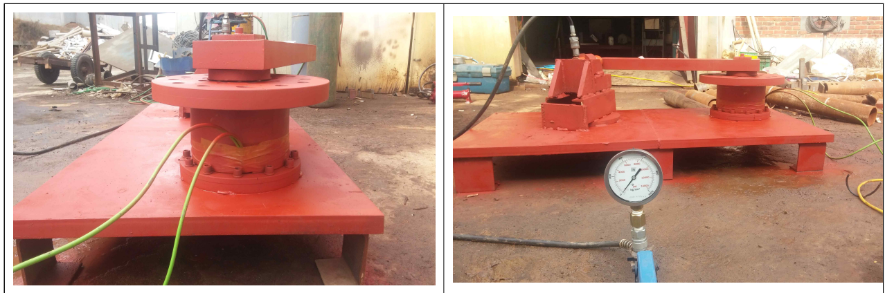
그림 2.3.3.72. 고 토크측정기 및 보정(calibration)장비 개발
