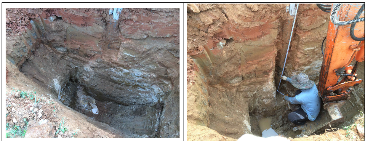
그림 2.3.3.55. 그라우팅 주입으로 인한 지반 보강 효과
