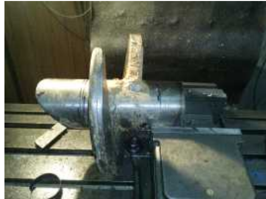
b. helical pile 선단부
