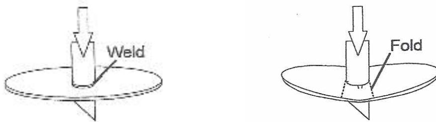
그림 2.3.1.17. Helix plate의 용접 및 접힘
