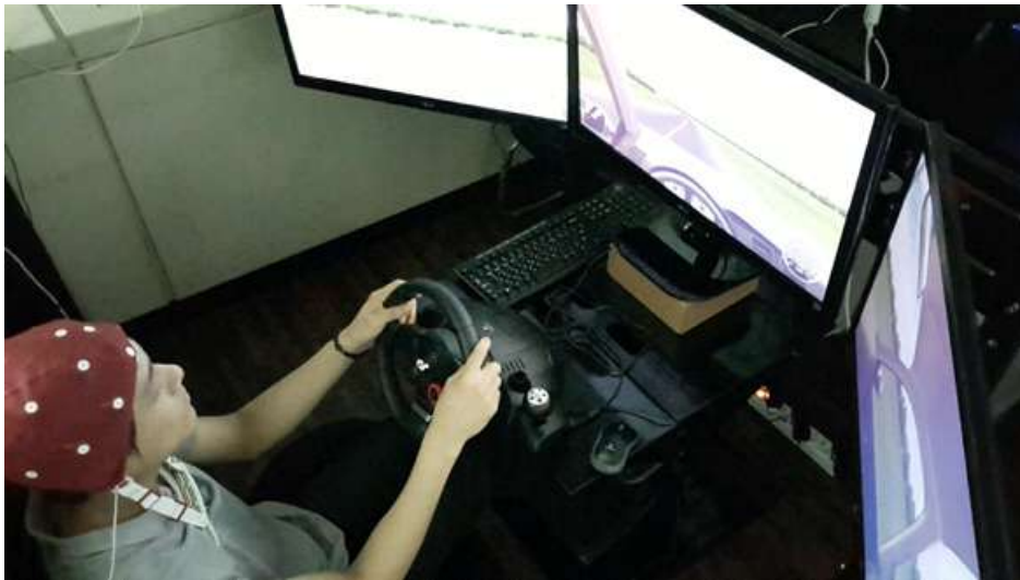
〈본 연구진이 구축한 운전자 피로도 측정을 위한 첨단 가상 체험 장치〉
