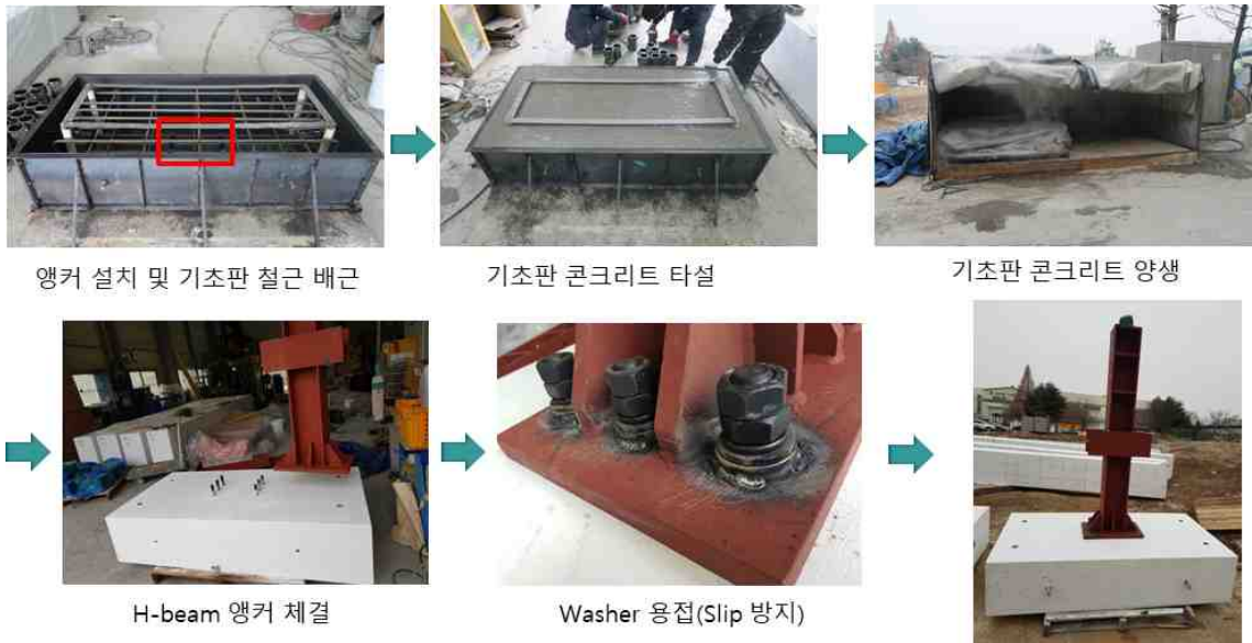
그림 6.10 반복하중을 받는 선설치앵커 실험체 제작과정
