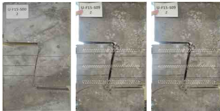
그림 5.10 인장철근비에 따른 균열양상 (좌-S00, 중-S09, 우-S16)
