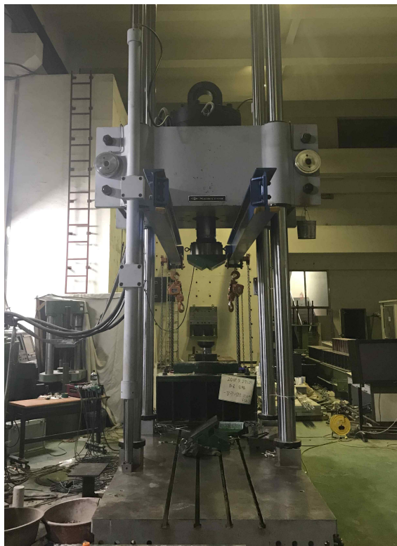
나. 그림 05. 만능재료시험기(UTM) 3000kN
