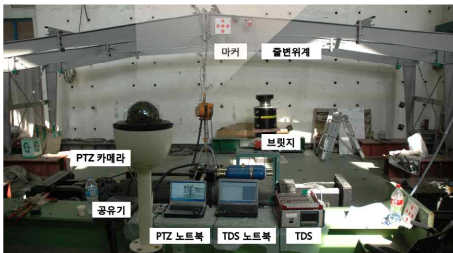
그림 08. PEB 처짐 측정 실험 전경
