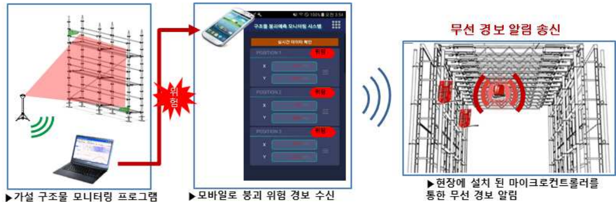
그림 6. 붕괴위험 구간 진입 시 무선 경보 알람 개념도
