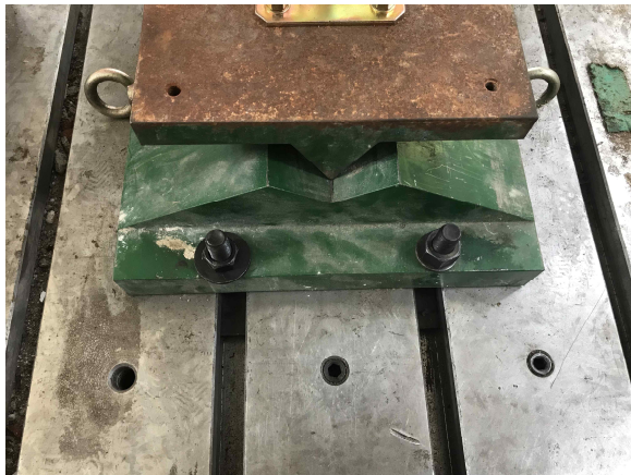
나. 그림 07. 하부 나이프엣지 설치
