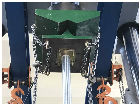
나. 그림 08. 상부 나이프엣지 설치
