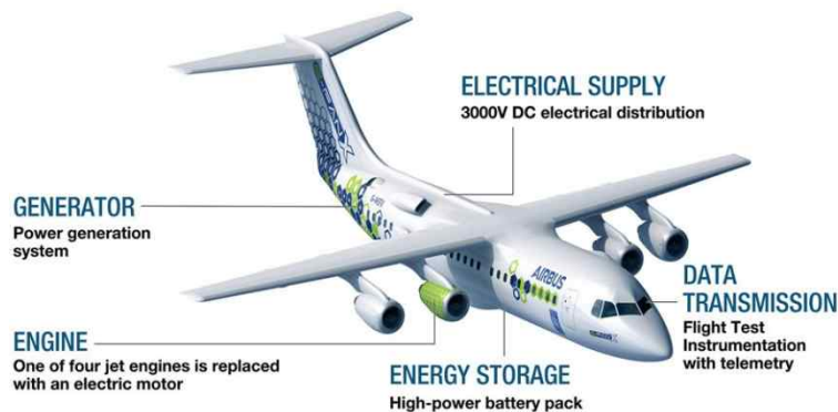
[그림 4.2] Airbus 'E-Fan X' 기술사양
