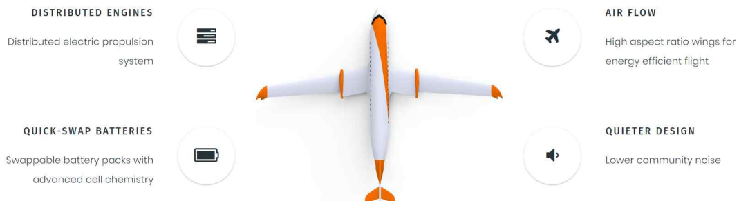
[그림 4.3] Wright Electric 전기여객기 기술사양
