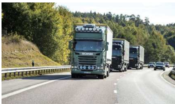
[그림 4.3] 폭스바겐 그룹의 자율 트럭 군집주행 시스템
