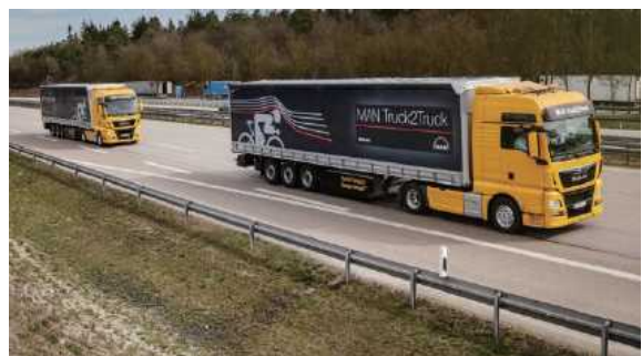
[그림 4.3] 폭스바겐 그룹의 자율 트럭 군집주행 시스템
