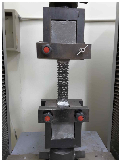
그림 62 Auxetic 격자 시험체 직접인장 시험 예
