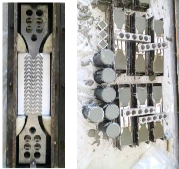
그림 61 직접인장 시험용 모르타르 무 매립방식 Auxetic 격자 시험체 제작 전경
