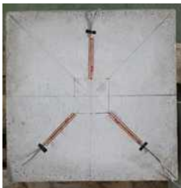
(c) 배면부 Strain gauge 부착
