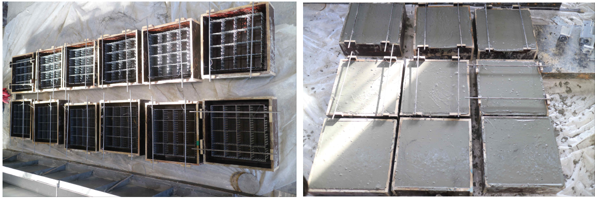
그림 84 충격하중 대응 복합체 제작 전경
