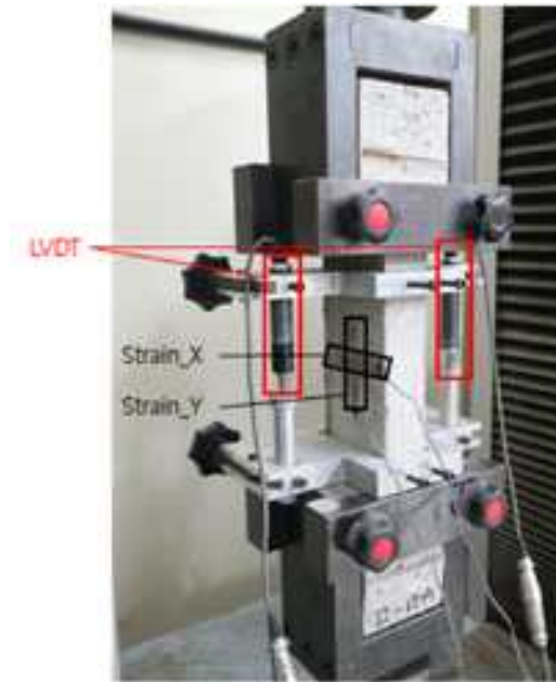
그림 76 격자체 매립 직접인장 시험 전경
