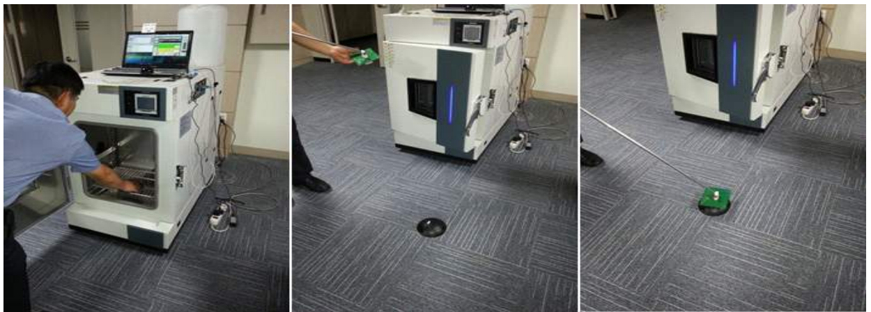
○주차센서 환경시험후 주차/출차 간이 시험검사 OK 결과
