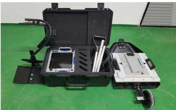
그림 2.17 GPR 탐사 장비 및 실험 전경
