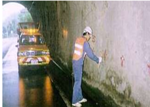
그림 2.23 음향계측 원리 및 시험사례
