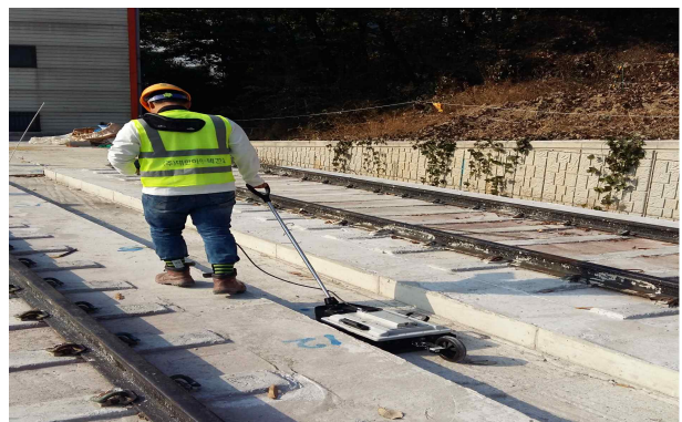
그림 2.17 GPR 탐사 장비 및 실험 전경
