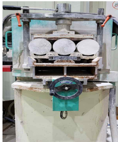
그림 4.6 초속경 시멘트 상·하면 연마 작업 전경
